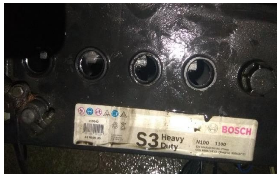
Figura 75. Revisión de electrolito en la celda de la batería. (Peso, 2018)
