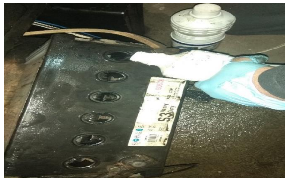
Figura 76. Colocación de agua destilada en la celda de la batería. (Peso, 2018)
