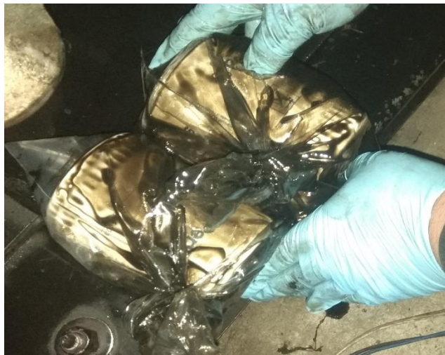
Figura 63. Extracción de los filtros de aceite. (Peso, 2018)
