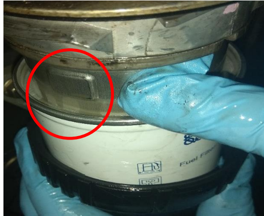
Figura 58. Guías de entrada de los filtros de combustible. (Peso, 2018)
