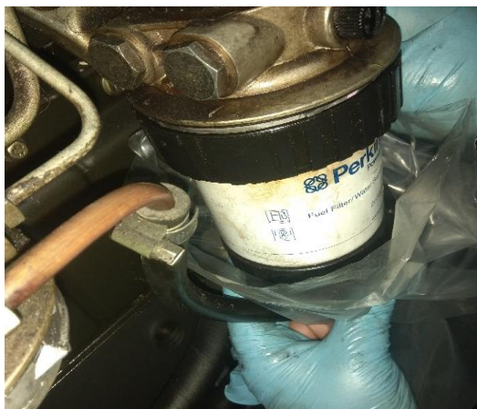
Figura 54. Extracción del filtro con trampa de agua. (Peso, 2018)
