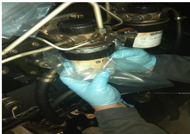
Figura 52. Extracción del filtro de combustible. (Peso, 2018)
