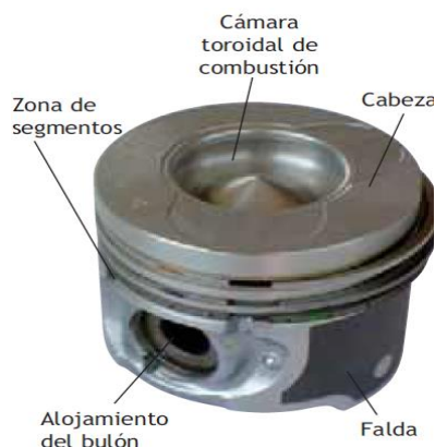
Figura 8. Pistón o Émbolo de un motor a diesel (Cordero, 2013)
