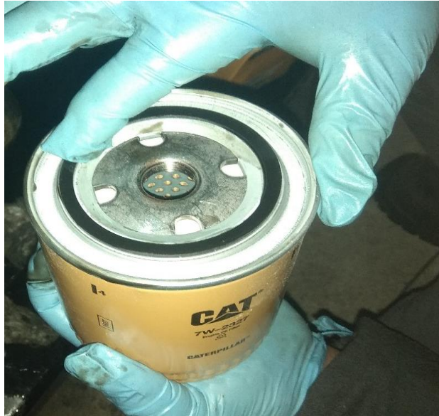
Figura 64. Lubricación del retenedor del filtro de aceite. (Peso, 2018)
