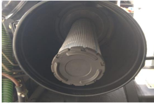
Figura 69. Extracción del filtro de aire secundario. (Peso, 2018)
