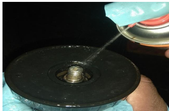
Figura 57. Limpieza de la trampa de agua. (Peso, 2018)
