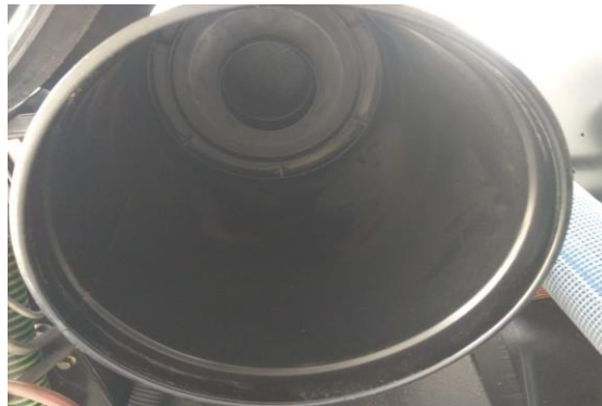
Figura 70. Interior del depurador de aire. (Peso, 2018)
