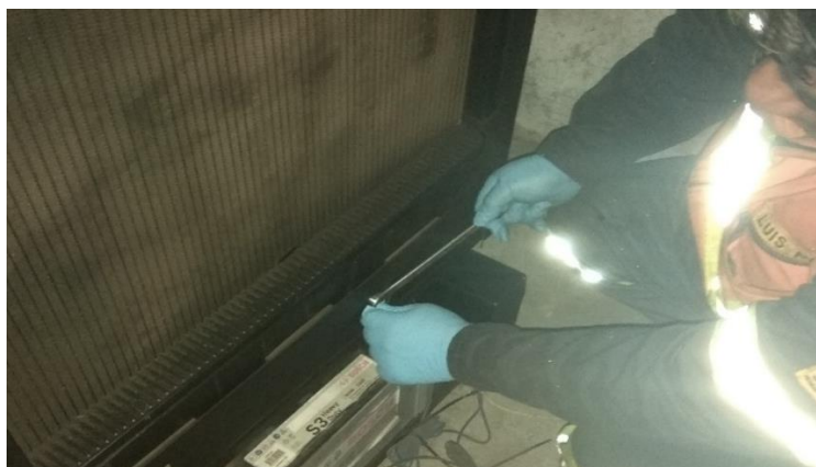
Figura 48. Ubicación desajuste del tapón del radiador. (Peso, 2018)
