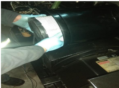
Figura 68. Extracción del filtro de aire primario. (Peso, 2018)
