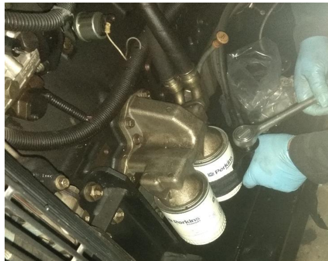
Figura 61. Extracción de los filtros de aceite. (Peso, 2018)
