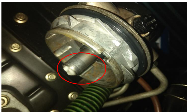
Figura 55. Formación de sales en la toma de combustible. (Peso, 2018)
