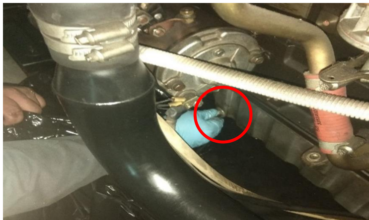
Figura 45. Ubicación del tapón del cárter. (Peso, 2018)
