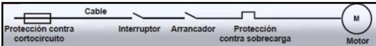
Figura 38. Esquema simplificado de conexión del motor eléctrico al suministro eléctrico (Copco, 2015)
