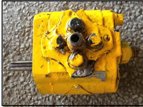
Figura 3.11 Bomba de engranajes
