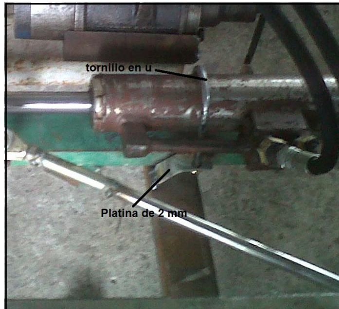
Figura 3.10 Mecanismo de sujeción
