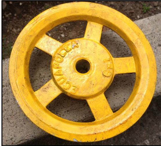
Figura: 3.17 Polea de la Bomba hidráulica
