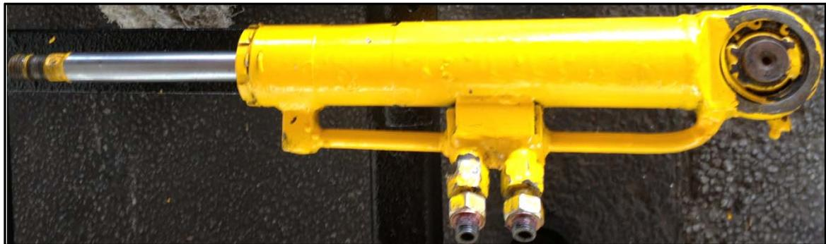
Figura 3.12 Cilindro Hidráulico doble efecto
