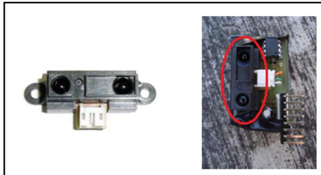
**Figura 3.9** *Sensor óptico infrarrojo Sharp GP2D12*
