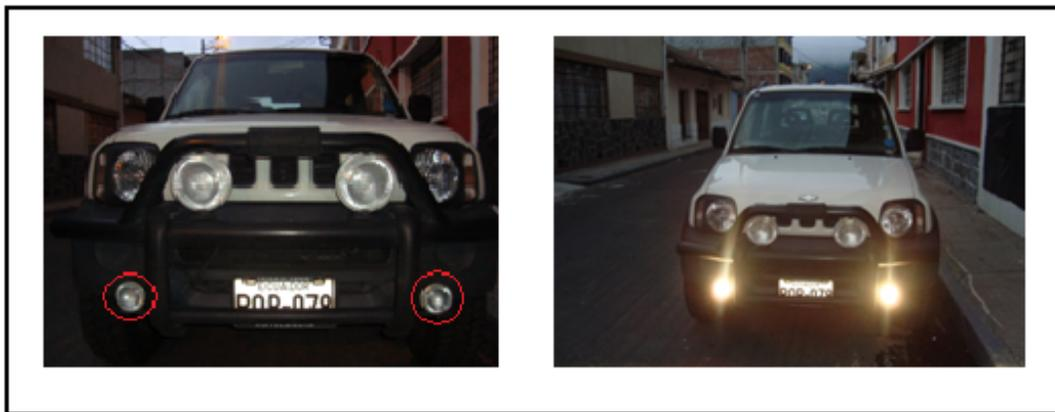
*Figura 3.19 Luces exteriores neblineras*
