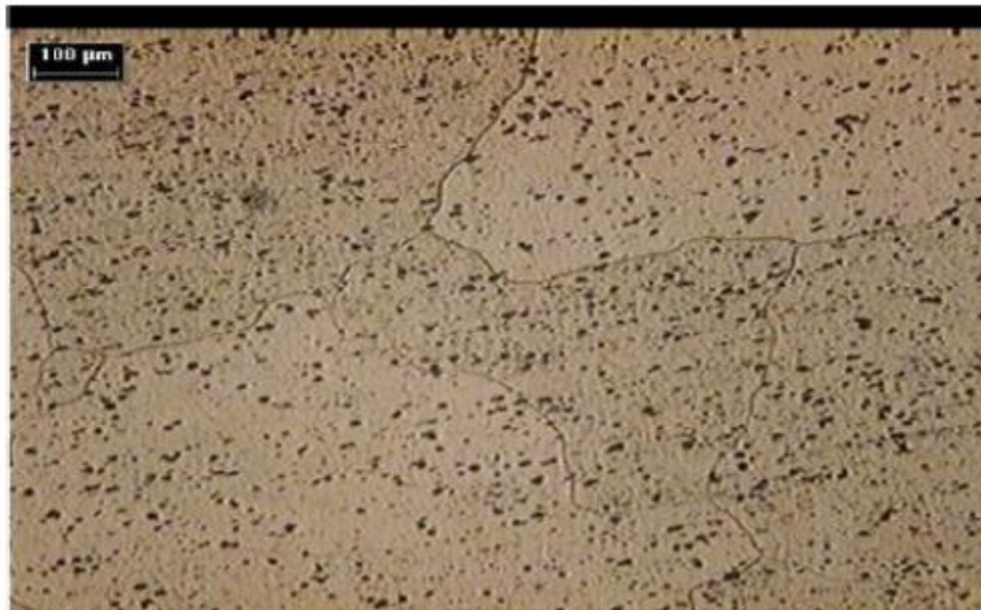
Figura 20. Microestructura de un aluminio 6061 T6 (50X).
