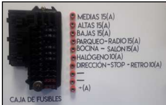
Figura 4.11 Caja de fusibles
