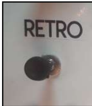
Figura 4.14 Interruptor de retro
