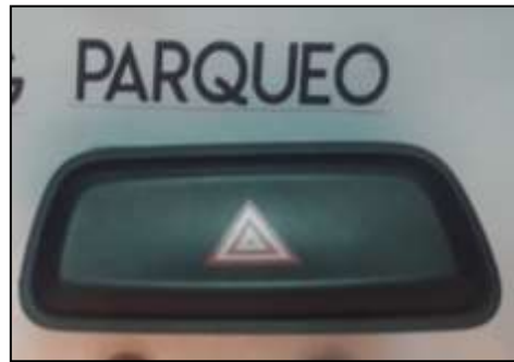
Figura 4.15 Interruptor de luces de parqueo
