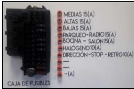
Figura 2.19 Fusilera o caja de fusibles
