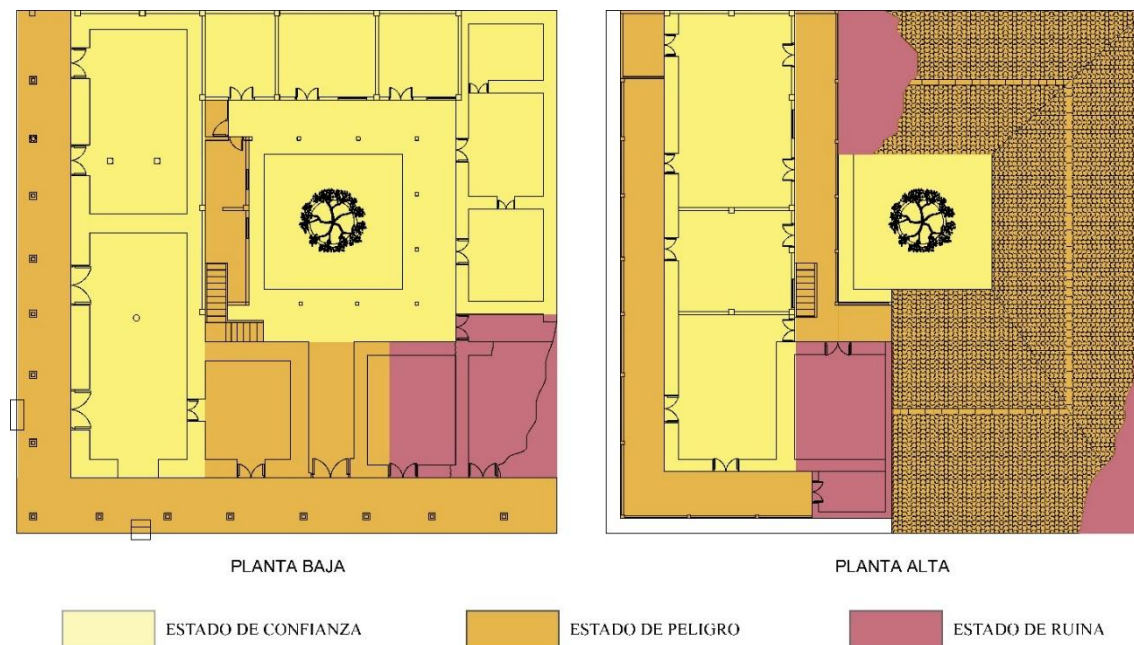
Figura 267. Estado general de la vivienda familia Carrión
