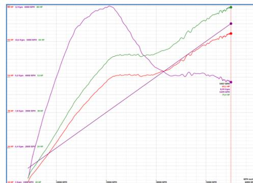
**Figura 5.** Torque y potencia con el múltiple estándar.
