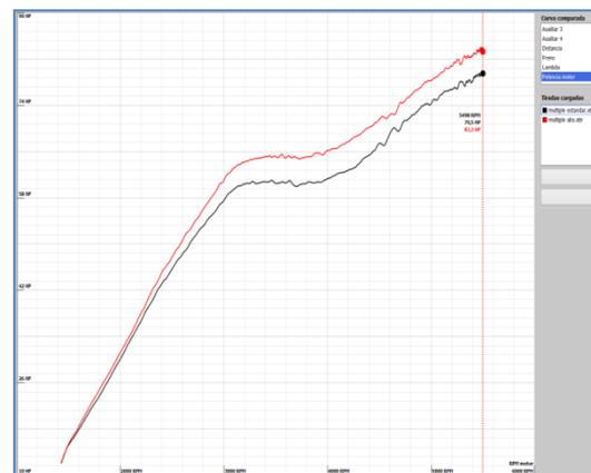
**Figura 7.** Comparación de potencia estándar vs plástico.
