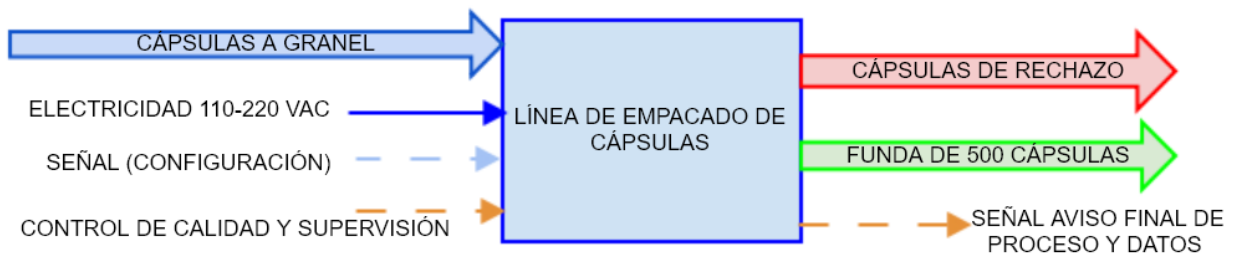
Figura 2.4. Diagrama funcional Nivel 0 línea de empaqueo de cápsulas
