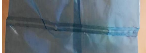
Figura 4.26 prueba de sellado ACEPTABLE
