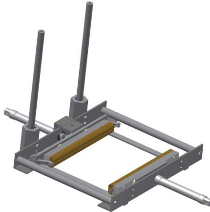
Figura 3.38 Modelo 3D. Módulo de sellado horizontal y carro móvil alimentador
