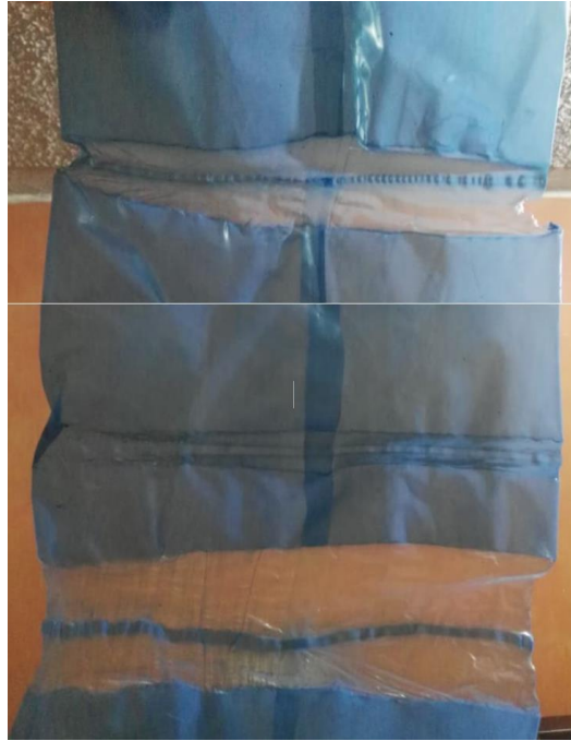
Figura 4.28 prueba de sellado DERRETIDO
