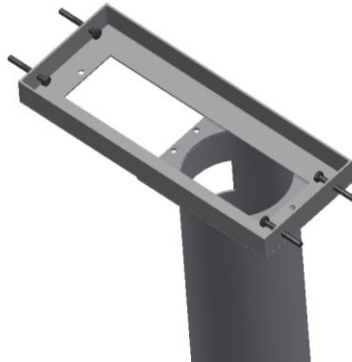
Figura 3.50 Pernos de sujeción de ducto de alimentación
