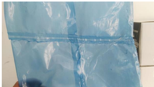
Figura 4.27 prueba de sellado ÓPTIMO
