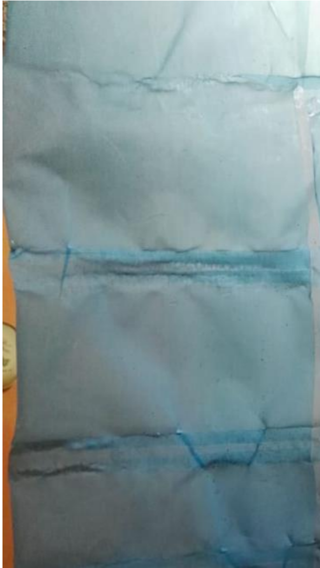
Figura 4.24 prueba de sellado DEFICIENTE
