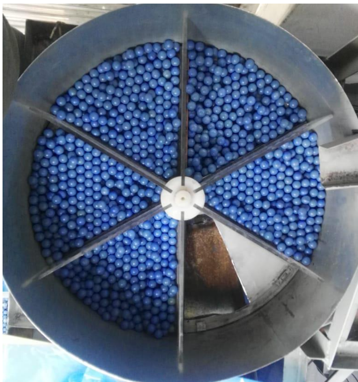
Figura 4.23 Alimentador circular con producto previamente agrupado
