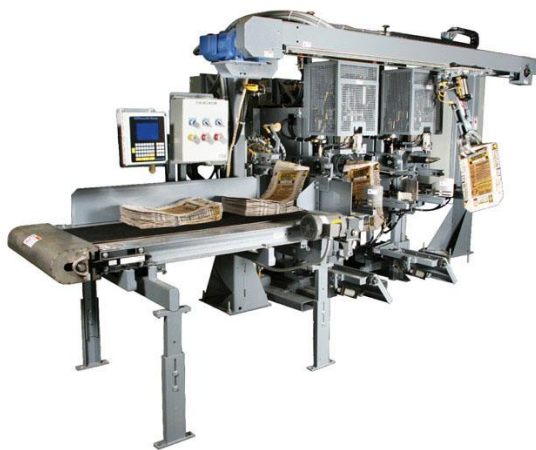
Figura 1.14. Empacadora automática ducto 509 [12].
