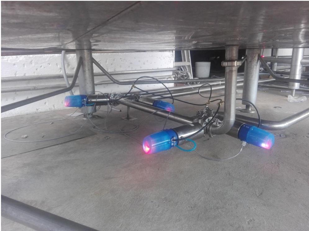
**Figura 74.** Conexión de tuberías y válvulas al silo de 20000 L
