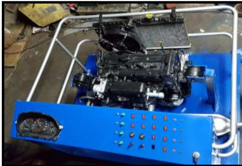
**Figura 32.** Banco de pruebas con un motor G4ED
