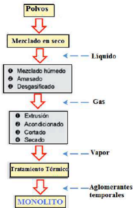
Fig. 3.10. Proceso de extrusión para la fabricación de monolitos cerámicos.
