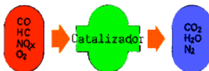
Fig. 3.13. Ejemplo del funcionamiento del catalizador
