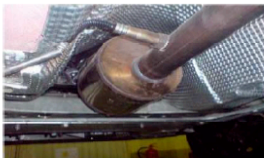
Fig. 3.3. Ubicación del convertidor catalítico en el automóvil
