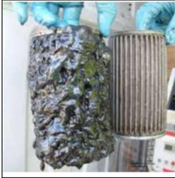
**Figura 2.14** Filtro con obstrucción microbiana junto a un filtro sin obstrucción
