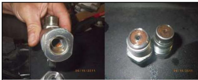
**Figura 2.17** Corrosión en componentes de un sistema Common Rail
