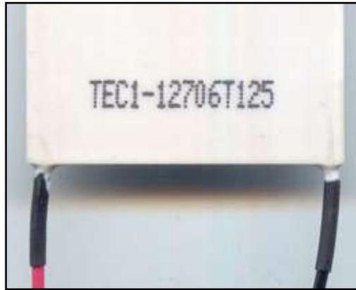
**Figura 3.16** Identificación del elemento Peltier
