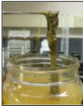
**Figura 2.15** Muestra de biopelícula en el fondo de un tanque de almacenamiento al granel
