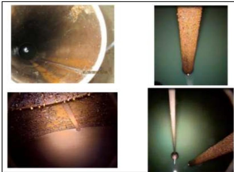
**Figura 2.19** Sistema de un tanque metálico de almacenamiento subterráneo (UST) con corrosión severa. Arriba a la izquierda: Apertura del tubo de llenado; Arriba a la derecha: Eje de la bomba sumergible; Abajo a la izquierda: Superficie del tanque mostrando la entrada o acceso hacia el tanque; Abajo a la derecha: Sonda del medidor del tanque y eje de la bomba.
