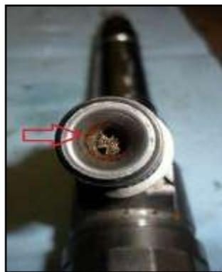
**Figura 2.16** Inyector con corrosión
