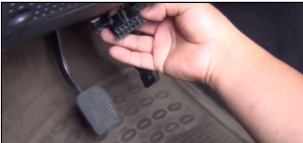
*Figura 13. Conexión de cables para diganostico del motor - A.*
