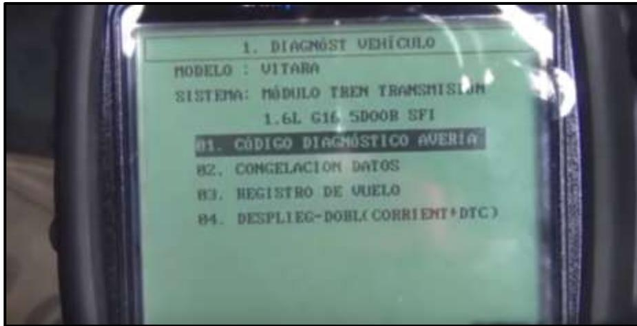
*Figura 23.* Identificación de codigo de diagnostico de averias en el motor.
