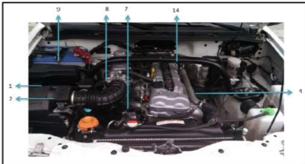
Figura 8. Ubicación en el vehículo de los sensores de información del sistema de inyección de combustible del motor J20.
