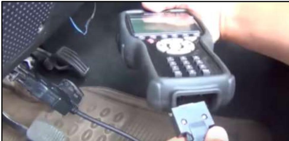
*Figura 16.* Conexión de cables para diagnóstico del motor con el multímetro B.
