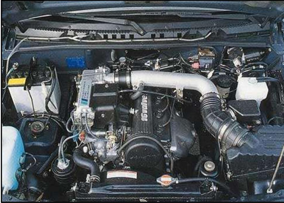
*Figura 6. Vista frontal Motor Suzuki serie J20.*
