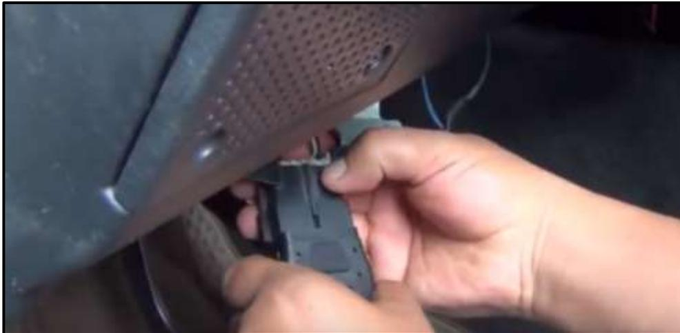
*Figura 14.* Conexión de cables para diagnóstico del motor - B.
