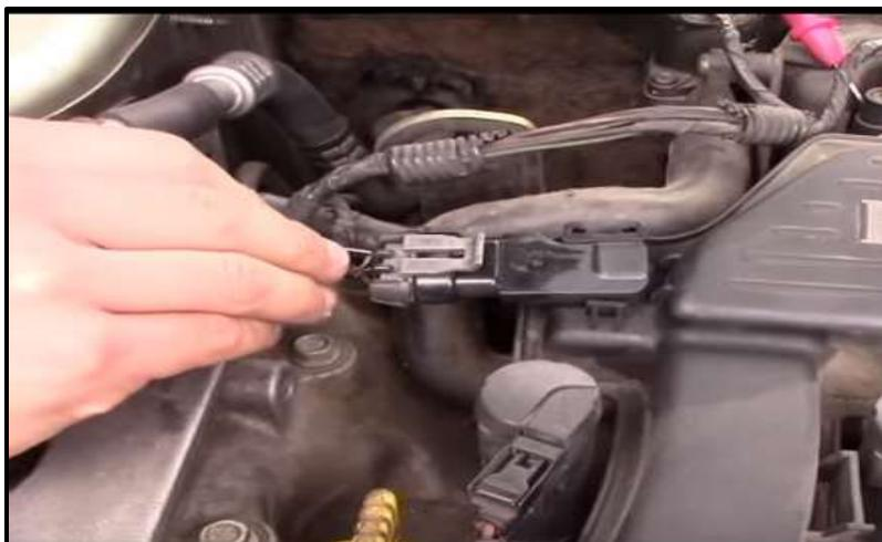
*Figura 25.* Conexión de multímetro para diagnóstico del sensor MAF.
