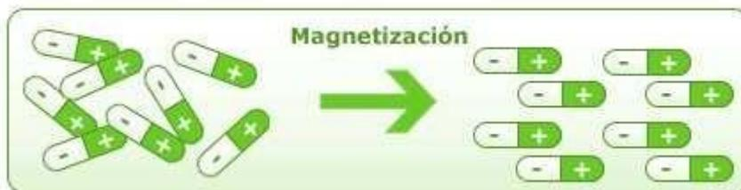
Figura 4.14. Alineación de las moléculas.
