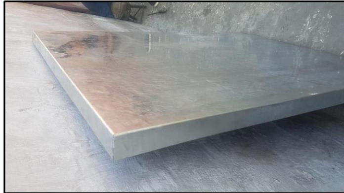
Figura 55. Plancha Galvanizada de Acero ASTM A63
