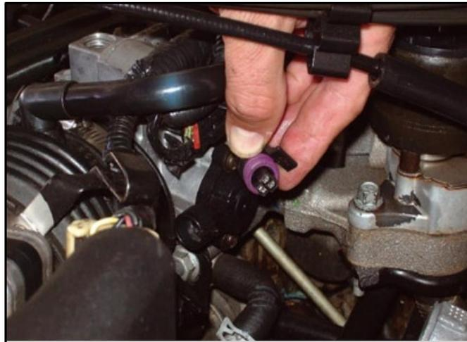
*Figura 29.* Revisión de cableado del sensor TPS. Recuperado de: [conevyt.org.mx](http://conevyt.org.mx)
