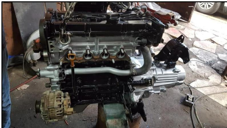
*Figura 80.* Motor G4ED con el acabado final de pintura.
