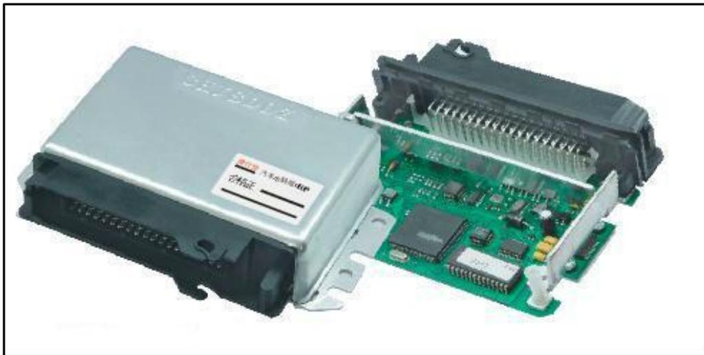
Figura 8. Módulo de control electrónico. Recuperado de spanish.alibaba.com
