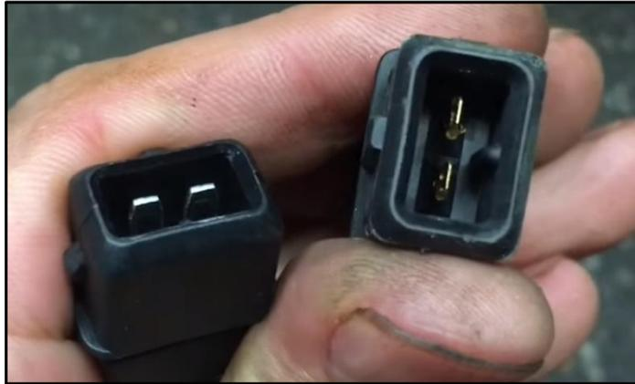
*Figura 32. Terminales del sensor CKP*
