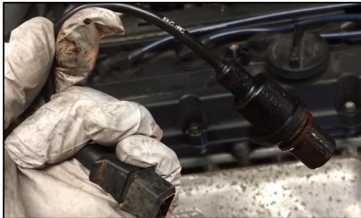
*Figura 31. Sensor CKP desmontado*
