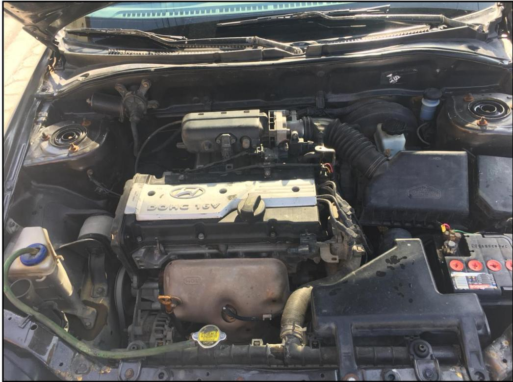
*Figura 2. Motor para el banco de pruebas DOHC 16 Válvulas.*
