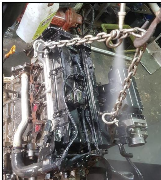
*Figura 67.* Limpieza del motor
