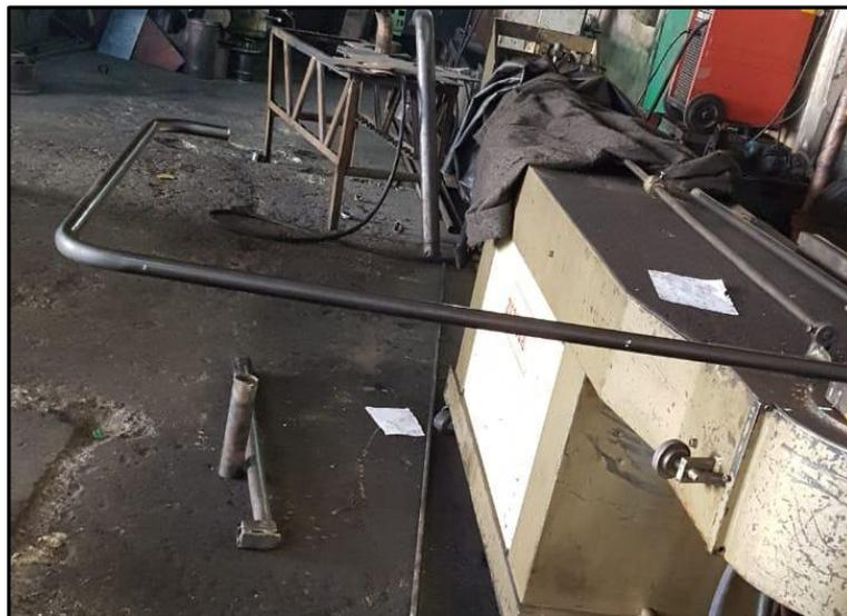
*Figura 71. Doblado y forma de la estructura de seguridad.*
