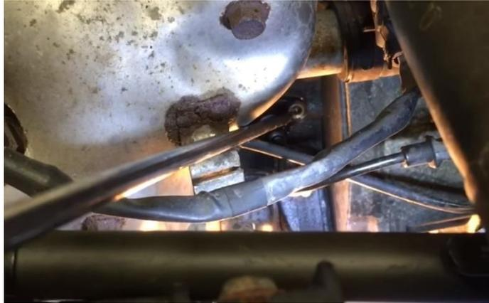
*Figura 30. Localización del sensor CKP*
