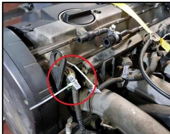
*Figura 33. Ubicación del sensor CMP en el vehículo.*
