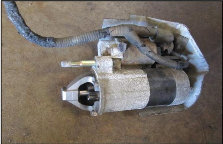
Figura 51. Motor de arranque desmontado
