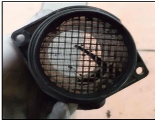
*Figura 15.* Caudalímetro de hilo caliente. Recuperado de: Nitro.pe
