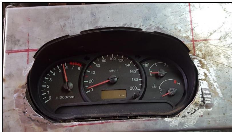
*Figura 76.* Indicadores del tablero en el banco de simulación.
