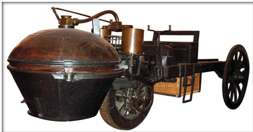
**Figura 1.** Automóvil de vapor de Cugnot, versión de 1771.
