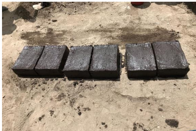
Imagen 11: Bloques de adobe
