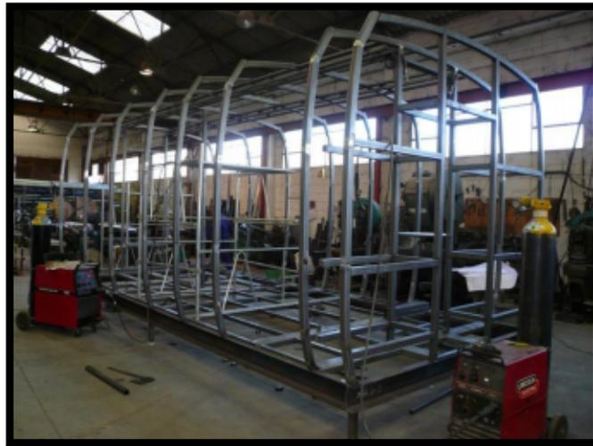
**Figura 2.4.** Superestructura de un autobus
