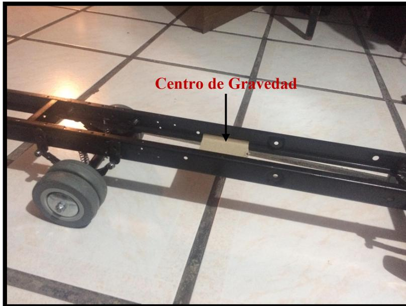
**Figura 39:** Centro de Gravedad previo instalación de la IMU
