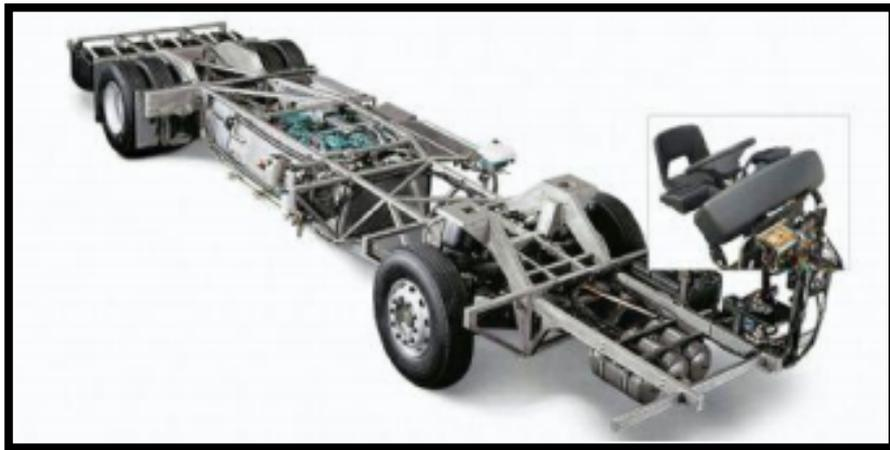
**Figura 2.3.** Arquitectura de construcción de un bastidor de un autobus
