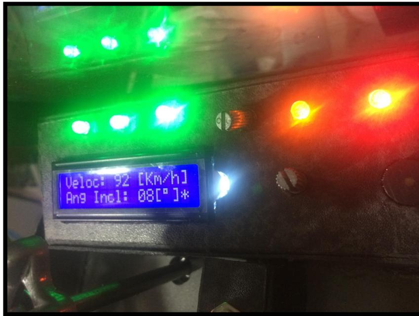
**Figura 47:** Máximo de velocidad y las alertas luminosa y acustica encendidas
