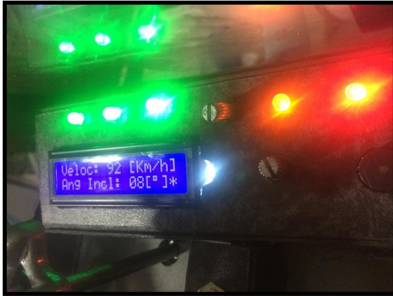
**Figura 44:** Alerta de Velocidad al Máximo, Leds de alerta anti-volteo encendidos
