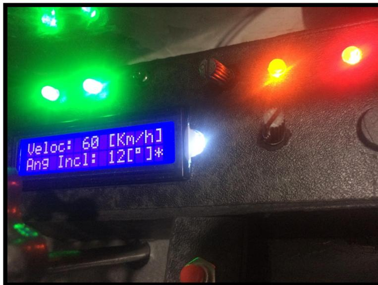
**Figura 46:** Prueba de Inclinación sobre plataforma, encendido de segunda alerta
