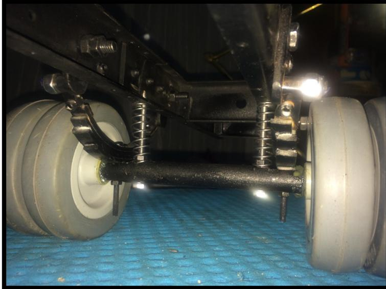
**Figura 25:** Sistema de Suspensión Aplicado al Modelo (Vista Inferior)
