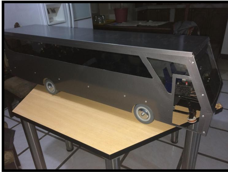
**Figura 29:** Remache de la carrocería al chasis del modelo
