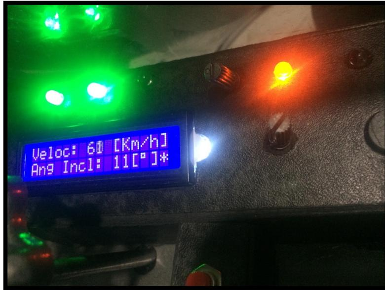
**Figura 45:** Prueba de Inclinación sobre plataforma, encendido de primera alerta
