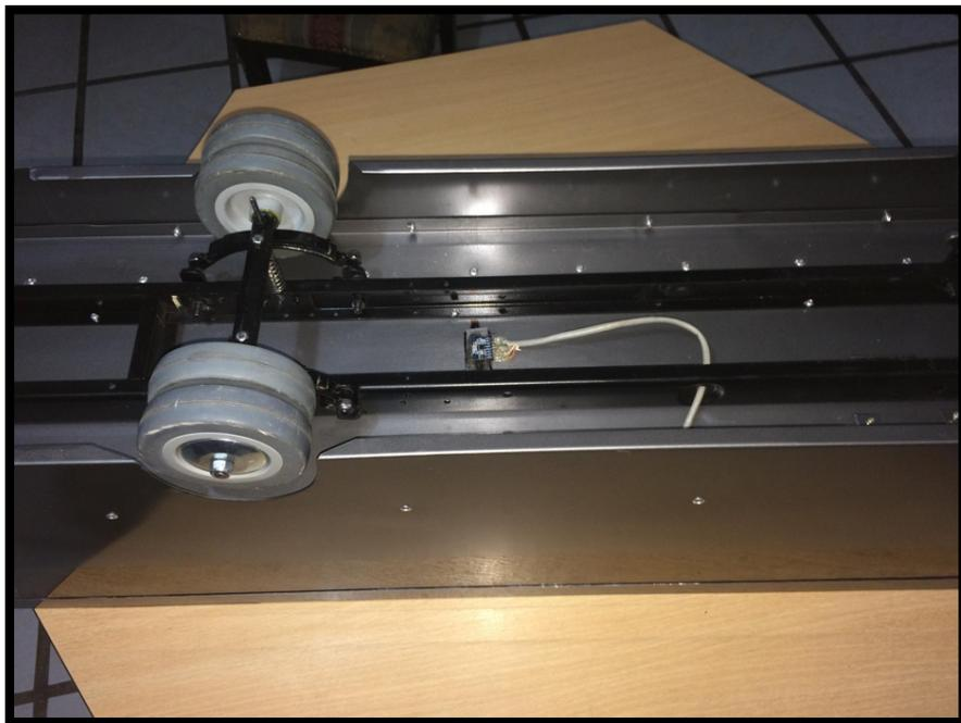
**Figura 40:** Instalacion de la IMU MPU – 6050 en el chasis del modelo
