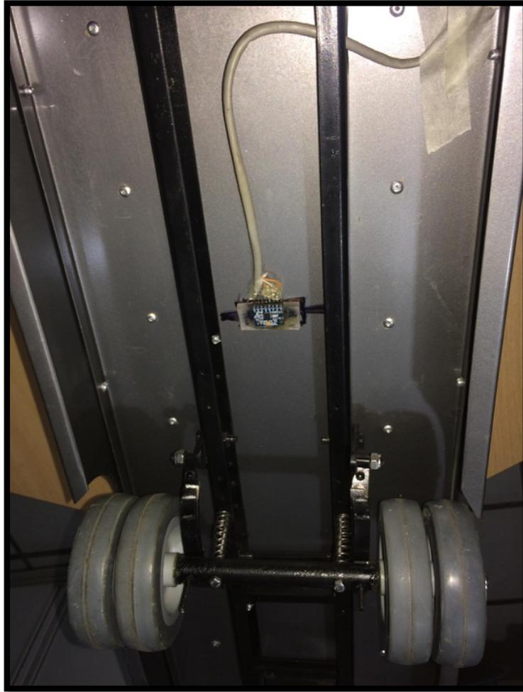
**Figura 41:** Vista Inferior de la Instalacion de IMU-MPU - 6050
