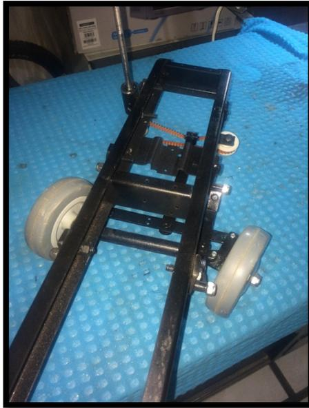
**Figura 23:** Sistema de Dirección aplicado al modelo a escala
