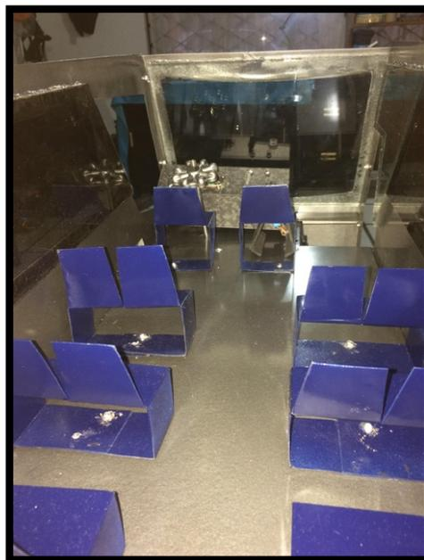
**Figura 30:** Instalación del peso muerto en el modelo (Asientos, Tablero de instrumentos y ventanas)
