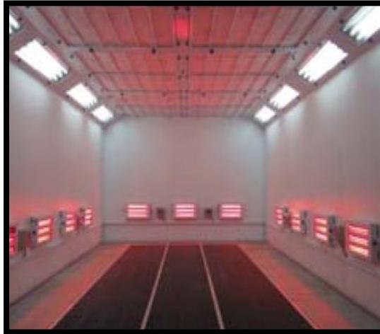
**Figura 4.** Cabina con paneles de infrarrojos
