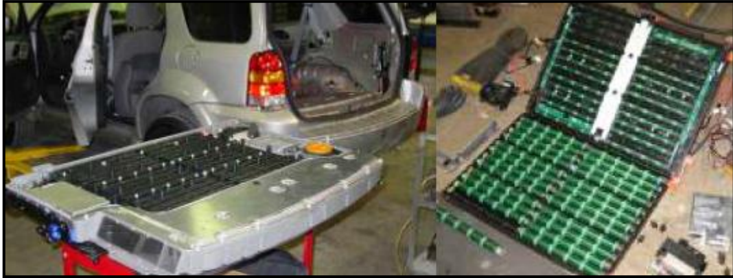
Figura 11. Batería del Ford Escape híbrido (TAAET, 2013)
