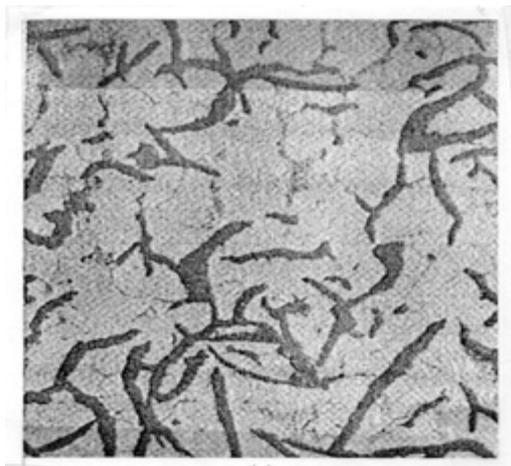
Figura 9: Microestructura fundición gris
