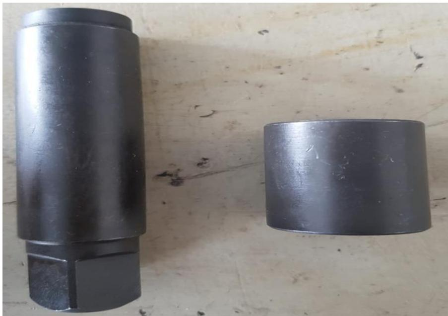
*Figura 4.1.32. Herramienta para la extracción de la Válvula Dosificadora.*
