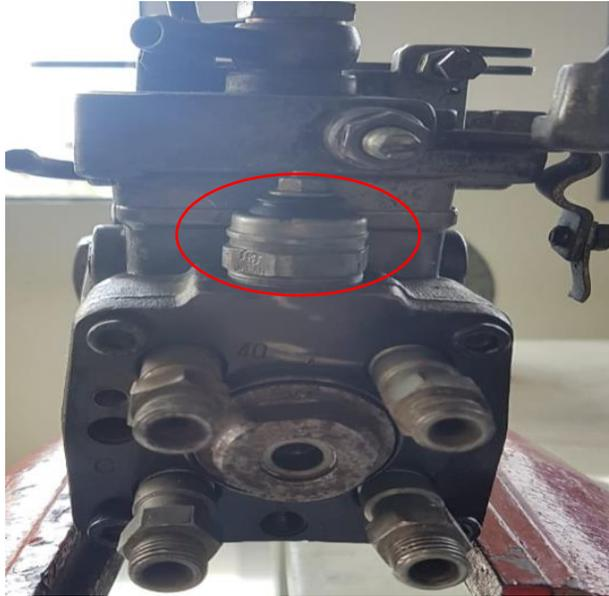
*Figura 4.3.20* Identificación del solenoide corte.
