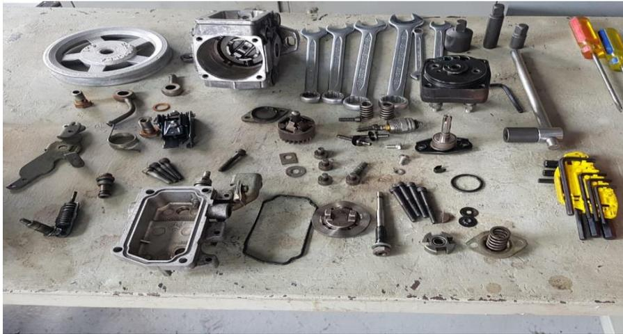
*Figura 4.1.30.* Elementos de la Bomba Rotativa.
