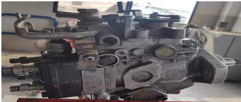
Figura 4.1.1. Bomba Rotativa Tipo VP 29 de Cuatro Elementos (Tobar 2018)
