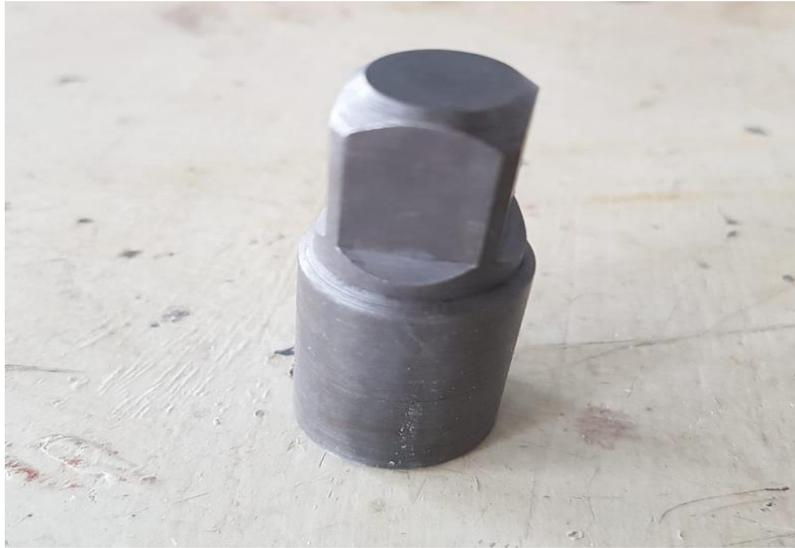
*Figura 4.1.33.* Herramienta para la extracción de la Palanca de Dosificación.
