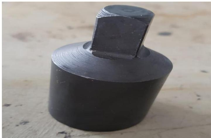
*Figura 4.1.34.* Herramienta para la extracción del tapón del cabezal.
