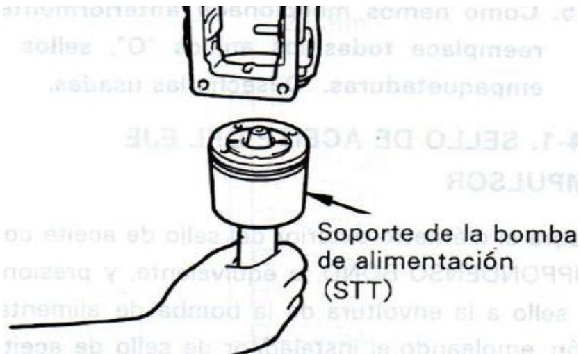
Figura 4.3.4 Montaje del conjunto en el soporte de la bomba.
