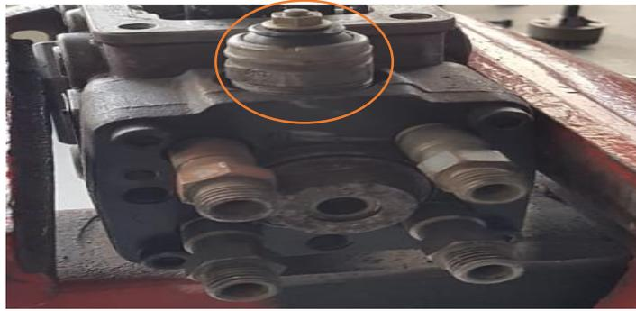
*Figura 4.1.16.* Solenoide y Cabezal de la Bomba Rotativa.
