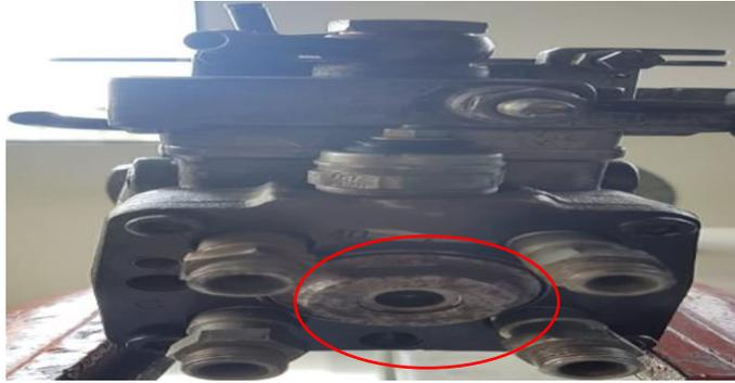
Figura 4.3.17 Cabeza distribuidora y válvula e suministro
