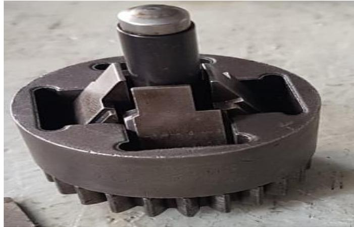
Figura 4.2.6 contrapesos del elemento distribuidor.
