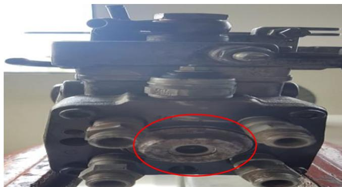
*Figura 4.1.13* Cabeza distribuidora y válvula e suministro
