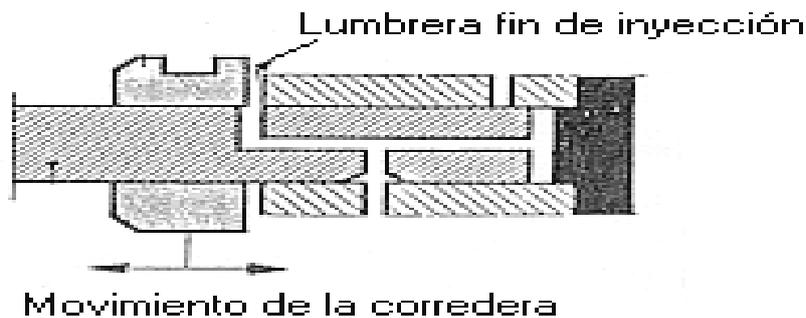
Figura 3.12.2. Final de la Inyección de Combustible.
