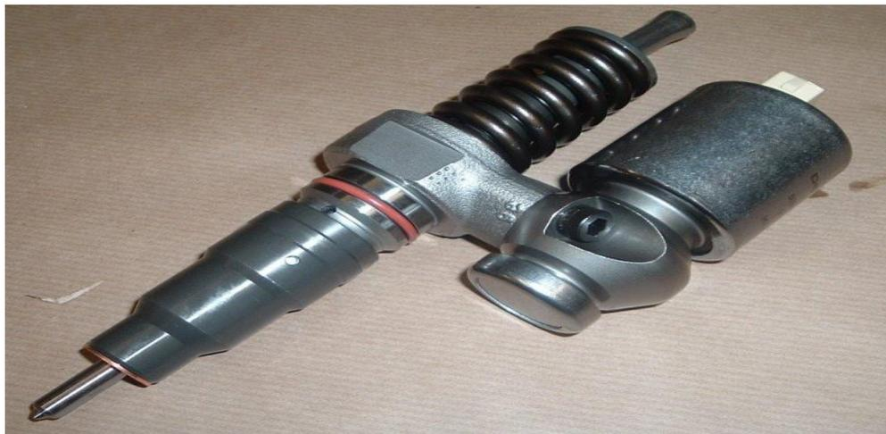
Figura 2.10.2. Inyector de solenoide
