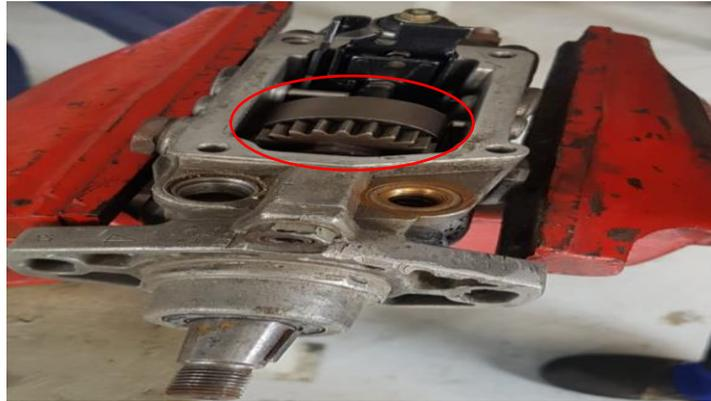
Figura 4.1.9. Elementos del Dosificador de Combustible.
