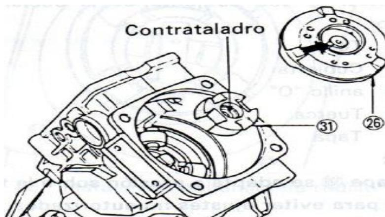
Figura 4.3.7 Instalación del acoplador y disco de levas.
