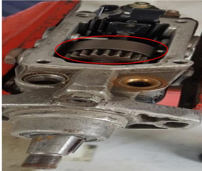
Figura 4.3.22 Conjunto de contrapesas instalado.
