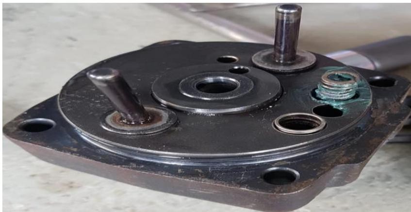
Figura 4.1.22. Cabezal Hidráulico de la Bomba Rotativa.
