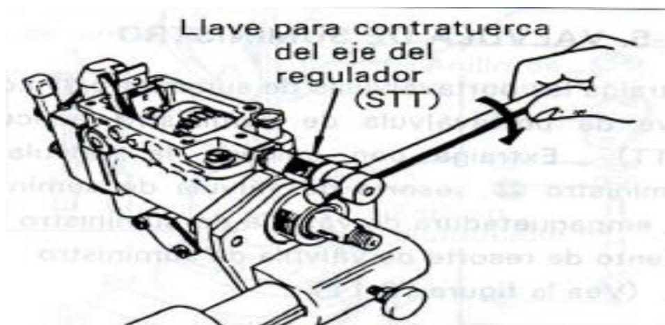
Figura 4.1.10 Identificación de la contra tuerca del mecanismo del regulador de caudal.
