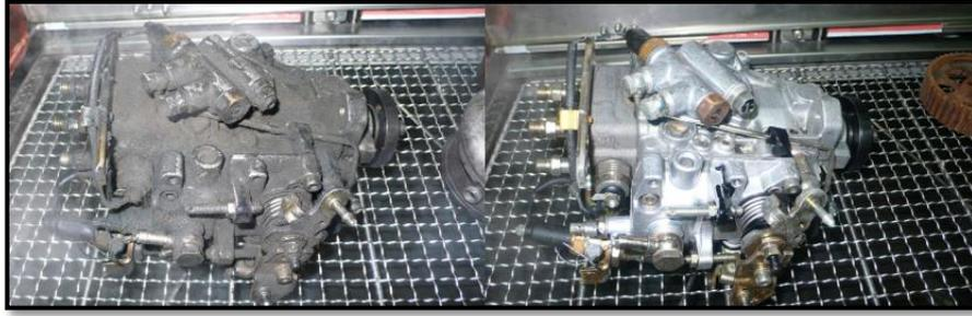
*Figura 50.* Acabados del sistema de limpieza con ultrasonido.
