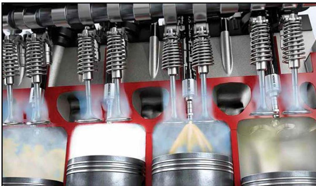
*Figura 2. Inyección a diésel.
