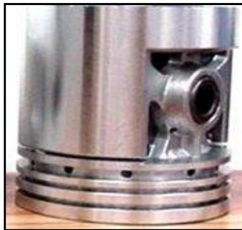
*Figura 8.* Pistones de aluminio fundido.
