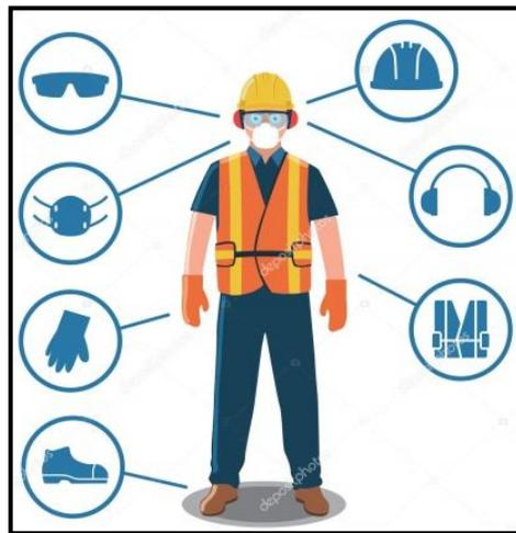
*Figura 71.* Equipos de protección personal necesarios en el laboratorio.
