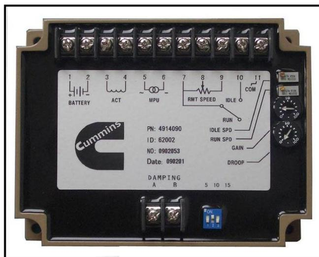
*Figura 19.* Regulador de velocidad electrónico.
