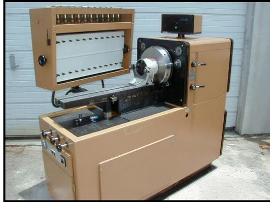
*Figura 47.* Equipo para bombas de inyección.
