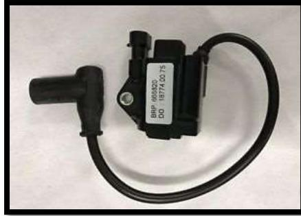
*Figura 34.* Bobina y cable del karting (Cevallos, 2017)
