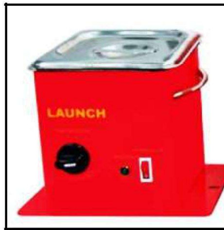
Figura 3. Recipiente para realizar la limpieza de inyectores por ultrasonido (Taaet, 2018)
