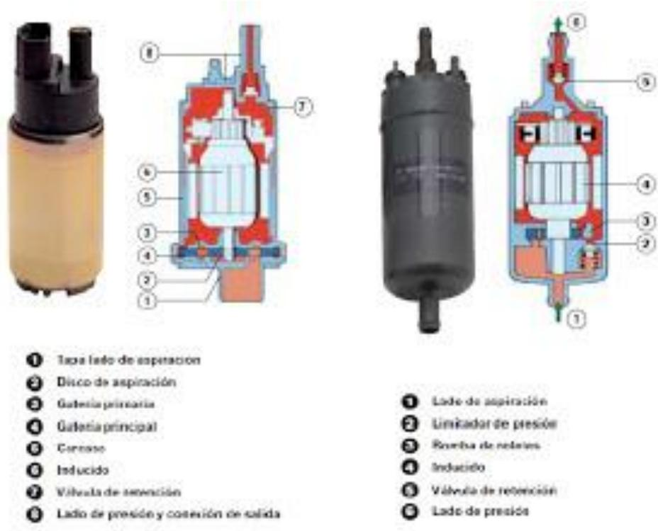
La bomba eléctrica de combustible forma parte del sistema de alimentación del automóvil y puede encontrarse tanto dentro del tanque del combustible como fuera de él, denominándose según el caso IN TANK o IN LINE respectivamente.
