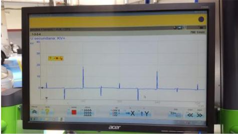
**Figura 13.** Proyecciones de los resultados del equipo FSA de BOSCH
