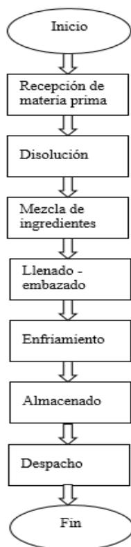
Figura 26. Flujograma para la preparación de helados
