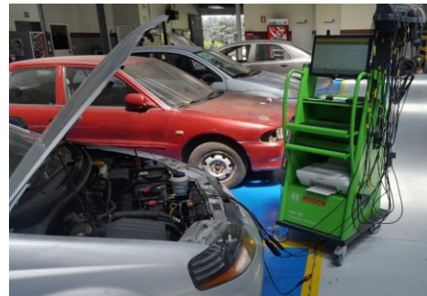
Ilustración 5: FSA BOSCH conectado al vehículo a Gasolina
