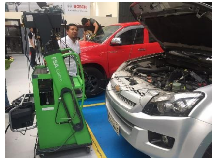
Ilustración 6: FSA BOSCH conectado al vehículo Diésel
