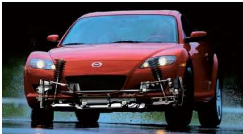
**Figura 13.** Sistema de suspensión del Mazda 3
