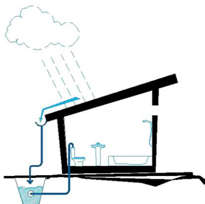
Imagen 11. Sistema de recolección de aguas lluvias
