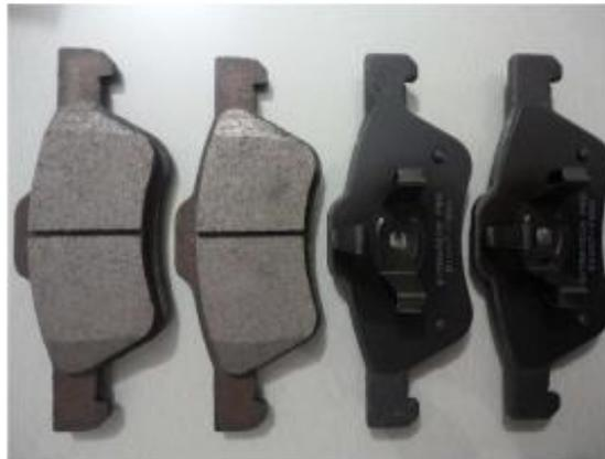
Ilustración 28 Pastillas Semimetálicas Ford Escape (Ford, 2015)
