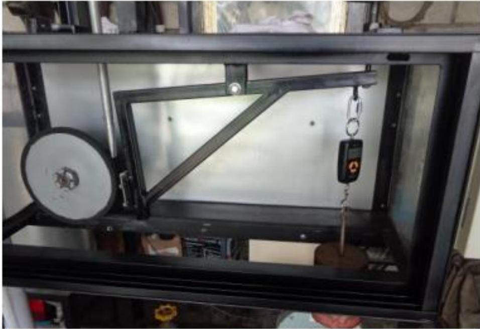
Figura 161. Pruebas de fuerza para brazo de palanca con dinamómetro.
