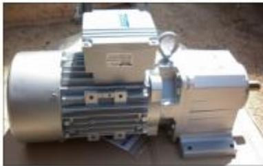
Fig. 10. Motoreductor.
