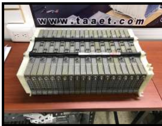
Figura 44. Conjunto de batería de alto voltaje del Toyota Prius C Híbrido (Manual de reparación Toyota)
