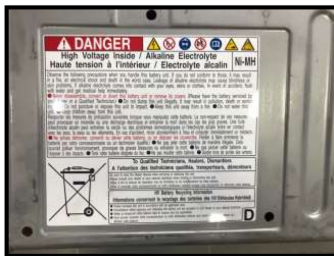
Figura 43. Sello de peligro de alto voltaje (TAEET Electronics)
