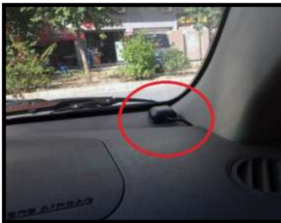
Figura 42. Montaje antena GPS. (Kevin de la A.)
