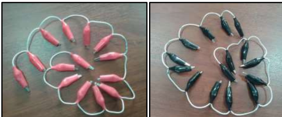
Figura 3.7 Conectores tipo pinza lagarto con conexión en paralelo Chong Terán
