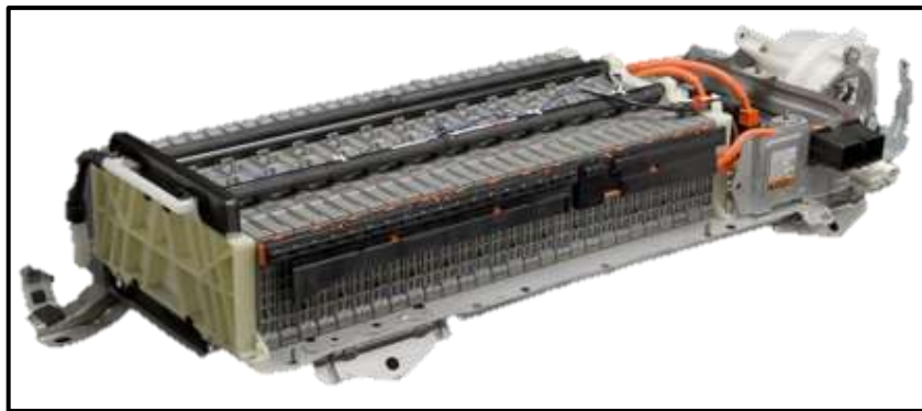
Figura 2.15 Batería desmontada de la cubierta de protección Toyoimport, 2016
