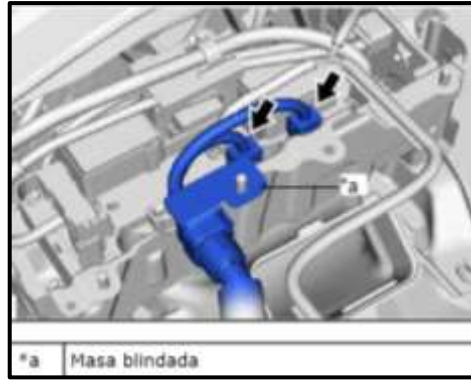
Figura 3.22 Cable de alta tensión Toyota
