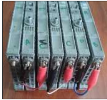
Figura 3.41 Conexión en serie de celdas Chong Terán
