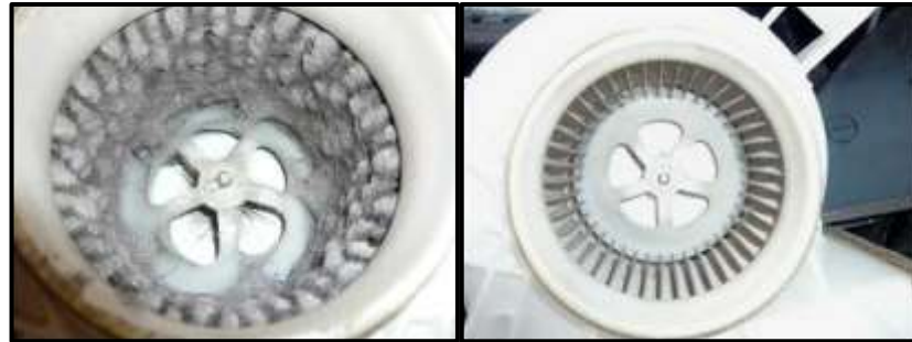
Figura 1.4 Mantenimiento de ventilador de batería HV Toyota, 2013
