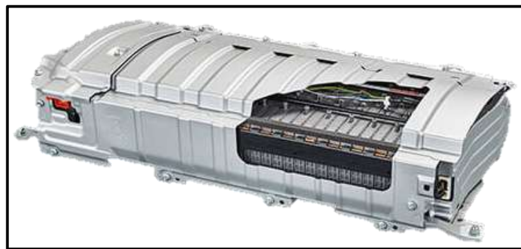
Figura 2.13 Batería de alta tensión Toyota
