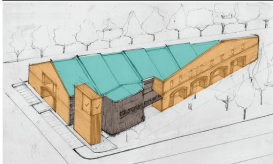
Este mercado posee una estructura mixta que combina perfectamente el acero con muros de ladrillo macizo que forman parte de su estructura. El proyecto inicia con la remodelación de una gran bodega en la cual se conserva gran parte de su infraestructura original. Los muros perimetrales son reciclados y además son reforzados mediante un sistema de estructura metálica que se deja a plena vista con fin de recuperar ese estilo industrial original que poseía la antigua estación.
