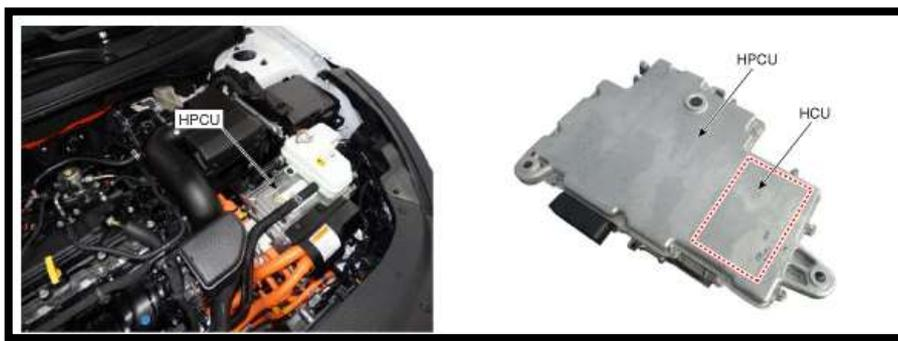
**Figura 20.** Ubicación del HCU del sistema híbrido del Hyundai Sonata
