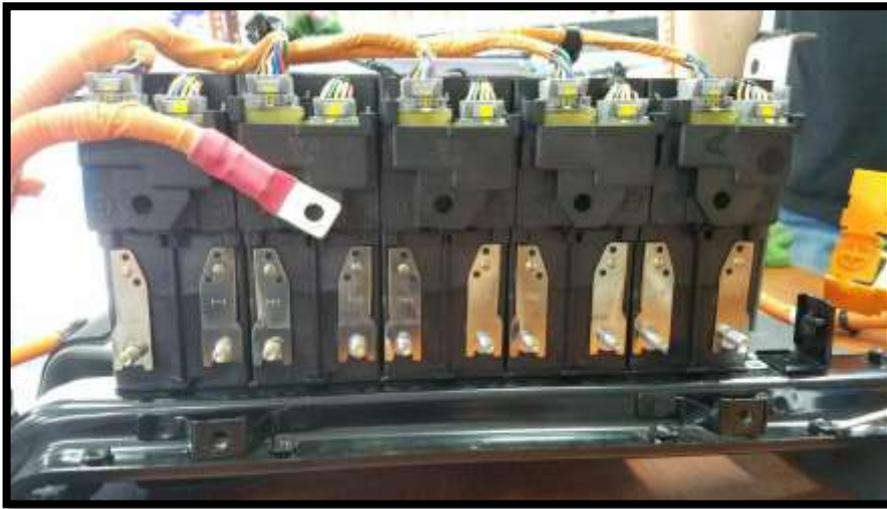
**Figura 59.** Conexión de alto voltaje
