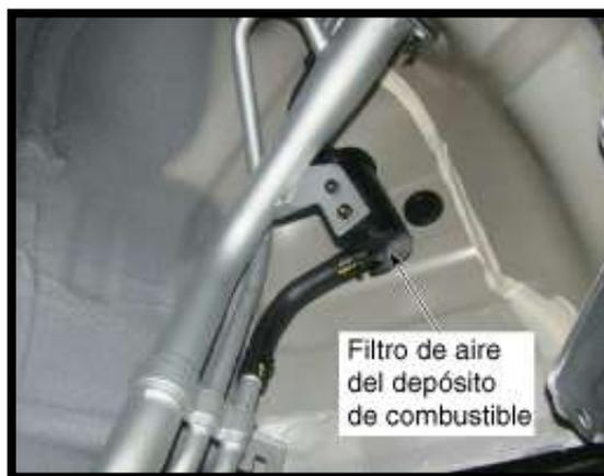
**Figura 30.** Filtro de aire de depósito de combustible del sistema híbrido
