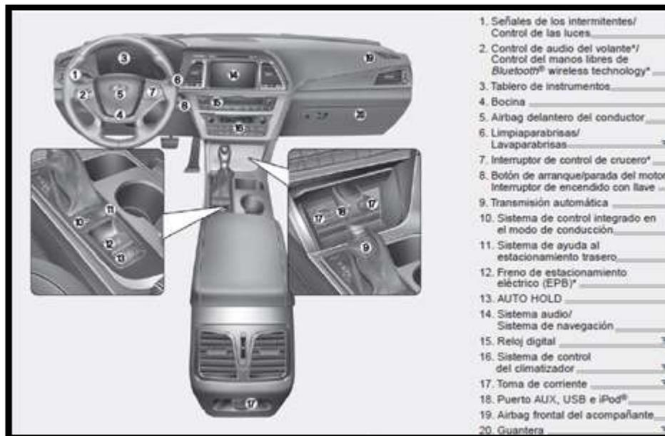
**Figura 15.** Vista general del panel de instrumentos del Hyundai Sonata
