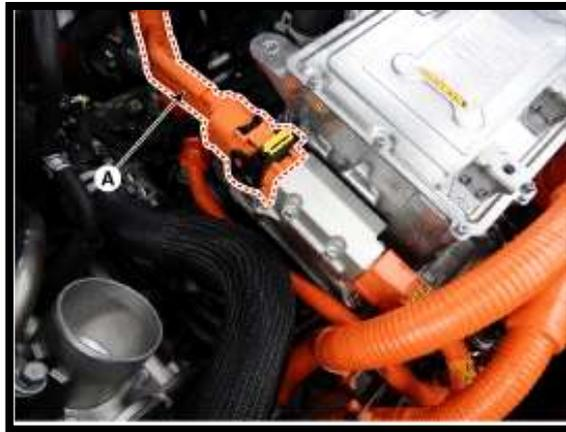
**Figura 47.** Desconexión de inversor
