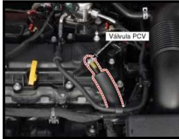
**Figura 27.** Válvula PCV del control de emisiones del sistema híbrido
