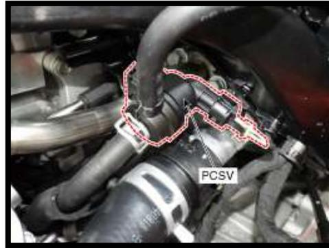
**Figura 29.** PCSV del control de emisiones del sistema híbrido
