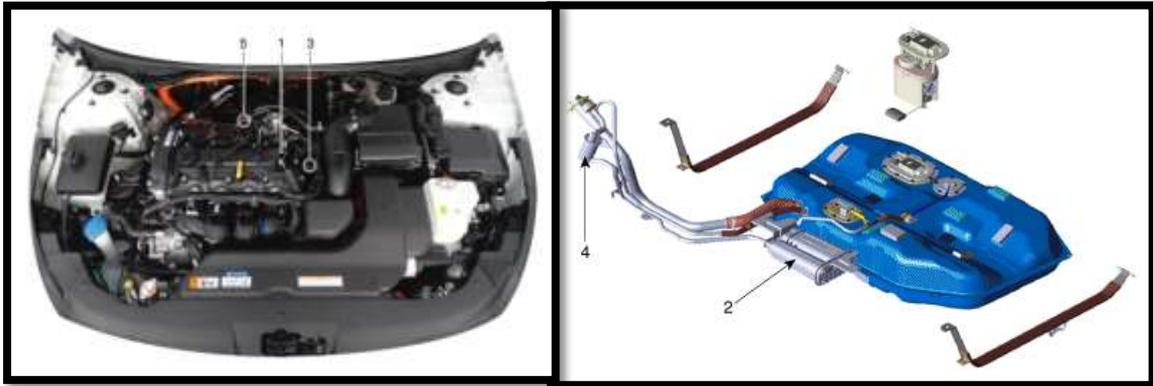
**Figura 26.** Componentes del sistema de control de emisiones del sistema híbrido
