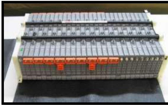
Figura 38. Paquete de celdas de batería (Toyota Prius) integrado por 28 celdas (Cise Electronics)
