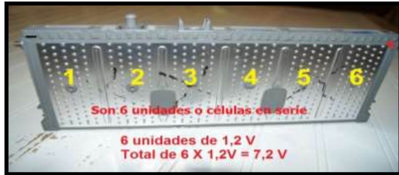
Figura 71. Celdas de la celda de una batería de Toyota Prius (Cise Electronics)
