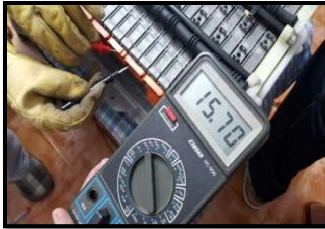
Figura 63. Medición de voltaje de cada pareja de módulos ( www.hybridcars.com/hybrid-owners-reconditioning-your-battery-is-a-possibility/ )
