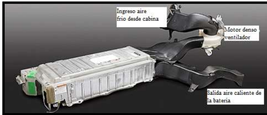
Figura 36. Batería de alto voltaje híbrida con el ducto de refrigeración ( www.autoavance.co/blog-tecnico-automotriz/184-componentes-de-vehiculos-hibridos-la-bateria-hv/ )
