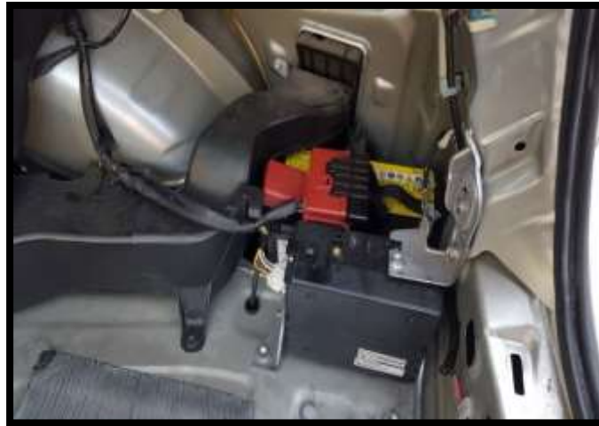
Figura 57. Ducto de refrigeración de batería híbrida ( www.hybridcars.com/hybrid-owners-reconditioning-your-battery-is-a-possibility/ )
