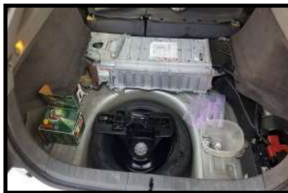
Figura 56. Ubicación de batería híbrida en el maletero en el Toyota Prius ( www.hybridcars.com/hybrid-owners-reconditioning-your-battery-is-a-possibility/ )
