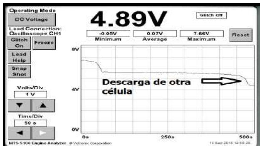
Figura 75. Descarga de celda con baja capacidad (Cise Electronics)
