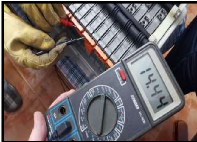
Figura 64. Diferencia de voltaje entre grupos de celdas Fuente: http://www.hybridcars.com/hybrid-owners-reconditioning-your-battery-is-a-possibility/
