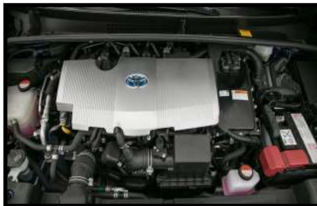
Figura 24. Motor de gasolina de ciclo Atkinson del Toyota Prius C ( laopinion.com/2017/11/28/toyota-prius-2018-el-hibrido-original-ahora-es-mas-seguro/ )
