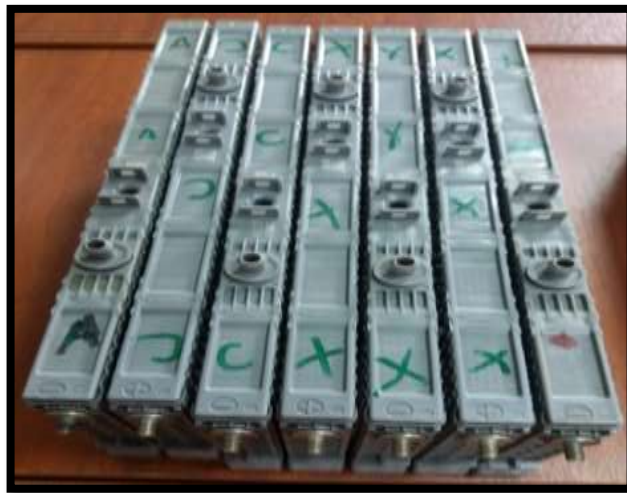
Figura 82. Celdas marcadas de la batería del Toyota Prius (Cise Electronics)
