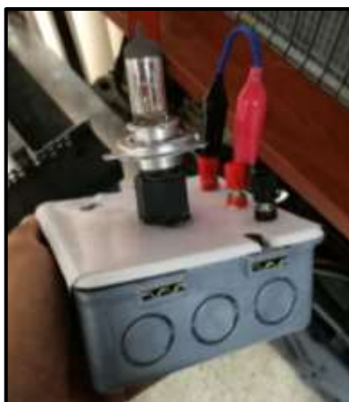
Figura 73 Alógeno de consumo para descarga de batería de alta tensión (Andrade, 2018)
