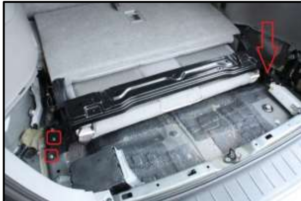
Figura 36 Proceso de extracción de la batería (Hybrid Automotive, 2016)
