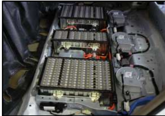
Figura 23 Paquete de baterías de alta tensión (Ecoelectric Battery , 2017)
