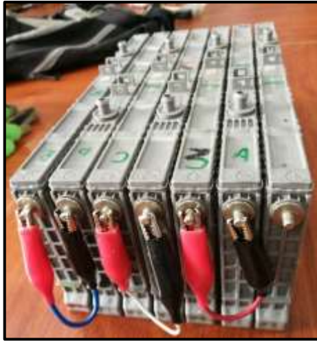
Figura 25 Conexión en serie de celdas (Andrade, 2018)
