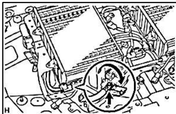
Figura 59 Proceso de extracción de la batería (Toyota, 2012)
