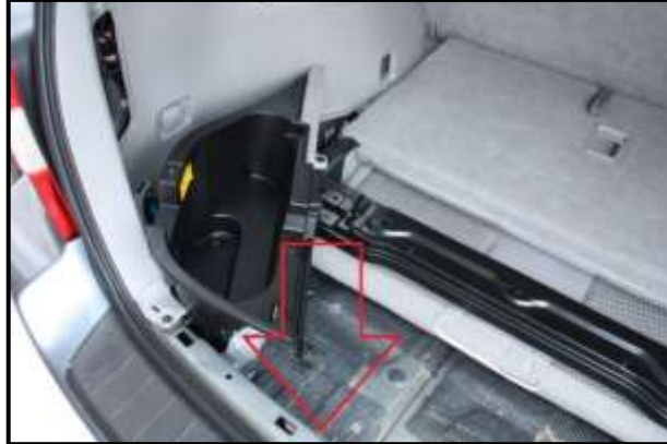
Figura 35 Proceso de extracción de la batería (Hybrid Automotive, 2016)
