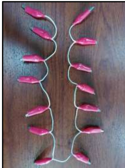
Figura 75 Lagartos para conexión en paralelo de las celdas (Andrade, 2018)
