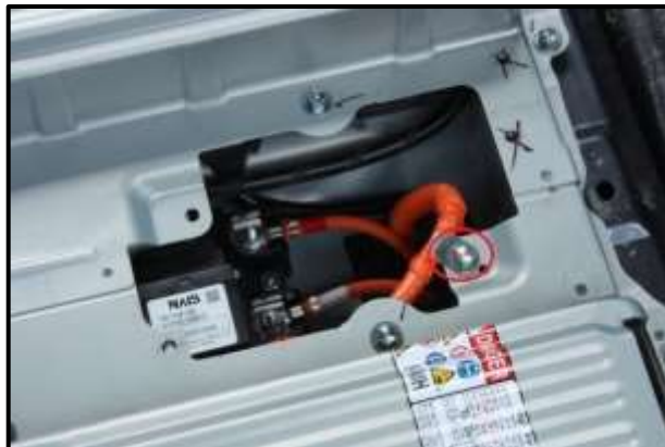
Figura 51 Proceso de extracción de la batería (Hybrid Automotive, 2016)
