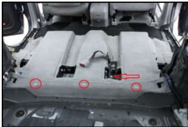
Figura 46 Proceso de extracción de la batería (Hybrid Automotive, 2016)
