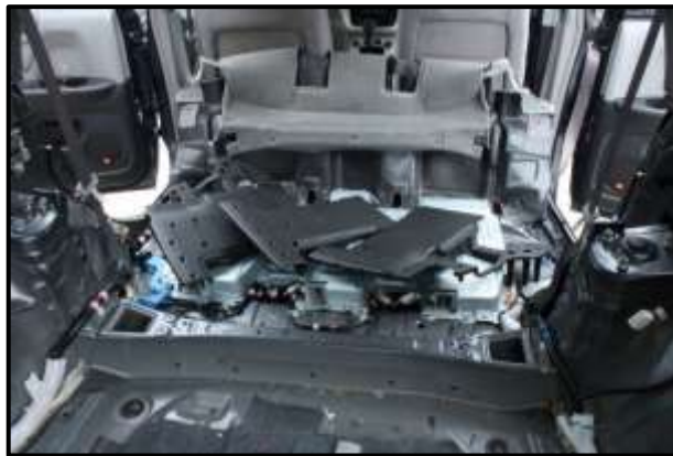
Figura 48 Proceso de extracción de la batería (Hybrid Automotive, 2016)
