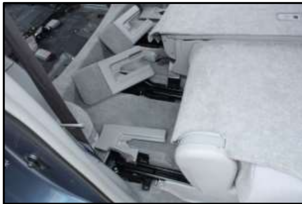
Figura 43 Proceso de extracción de la batería (Hybrid Automotive, 2016)
