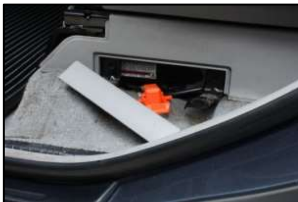
Figura 39 Proceso de extracción de la batería (Hybrid Automotive, 2016)
