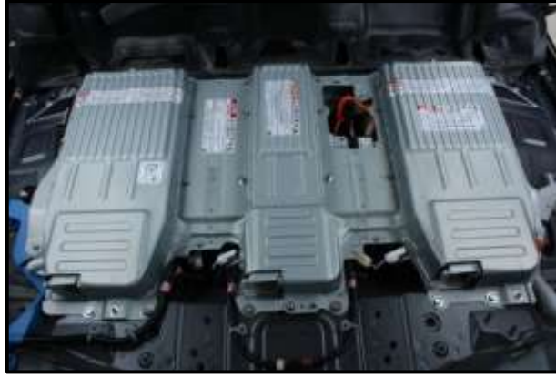
Figura 52 Proceso de extracción de la batería (Hybrid Automotive, 2016)
