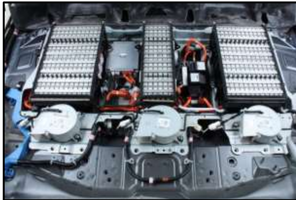
Figura 53 Proceso de extracción de la batería (Hybrid Automotive, 2016)
