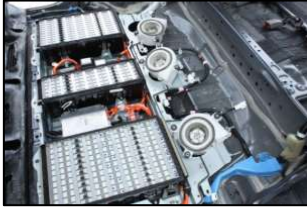
Figura 54 Proceso de extracción de la batería (Hybrid Automotive, 2016)
