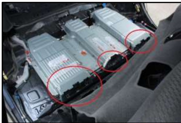
Figura 49 Proceso de extracción de la batería (Hybrid Automotive, 2016)
