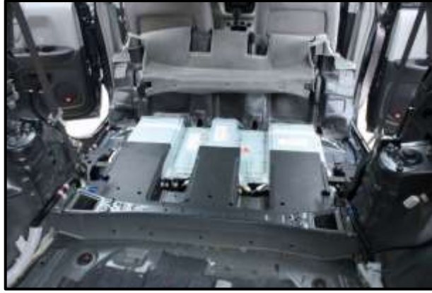
Figura 47 Proceso de extracción de la batería (Hybrid Automotive, 2016)
