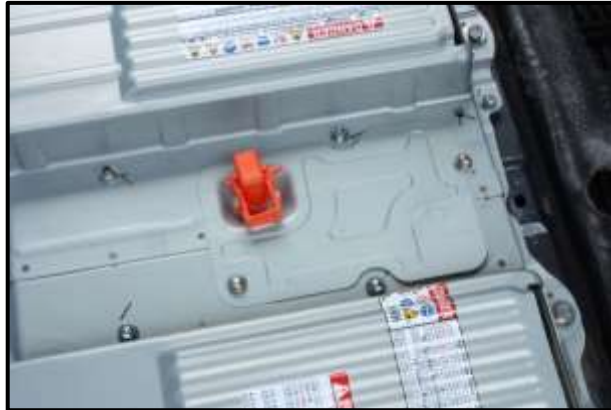
Figura 50 Proceso de extracción de la batería (Hybrid Automotive, 2016)
