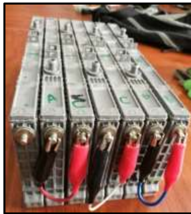
Figura 70 Celdas conectadas en serie (Andrade, 2018)
