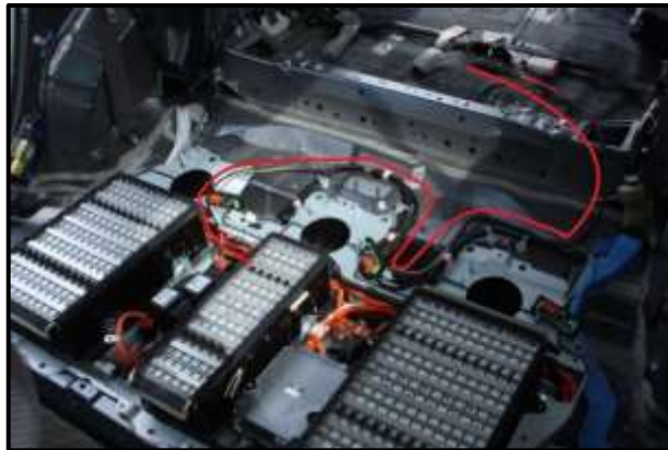
Figura 55 Proceso de extracción de la batería (Hybrid Automotive, 2016)
