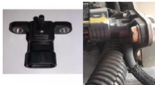
**Ilustración 1.** Sensor de presión de turbo (SPT)
