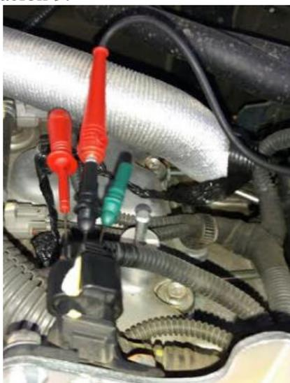
**Ilustración 9.** Señal de sensor (BPS)
