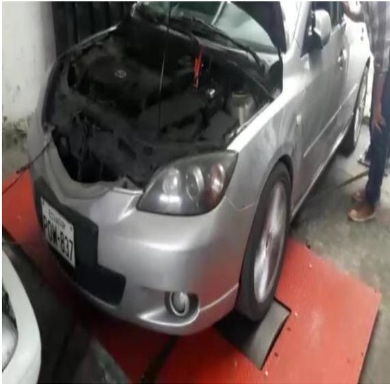
**Figura 3.** Imagen de vehículo utilizado prueba dinámometro
