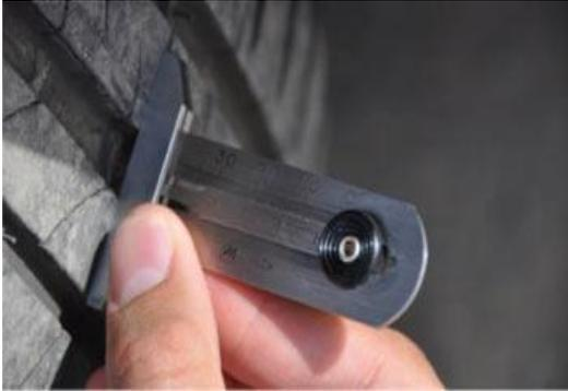
**Figura 24.** Medidor de Profundidad Profesional.
