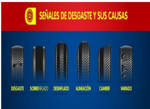
**Figura 25.** Señales de Desgaste del Neumático.
