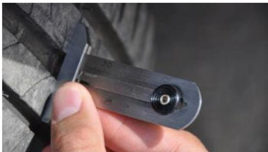
**Figura 8.** Medidor De Profundidad.
