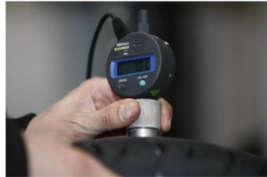
**Figura 27.** Medidor de Profundidad de Desgaste Electrónico.
