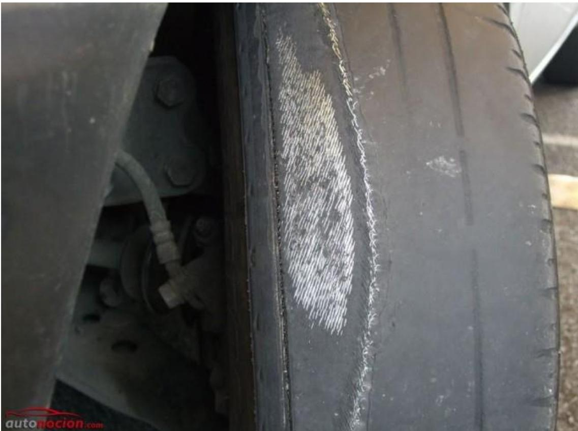
**Desgaste en la parte central del neumático:**
