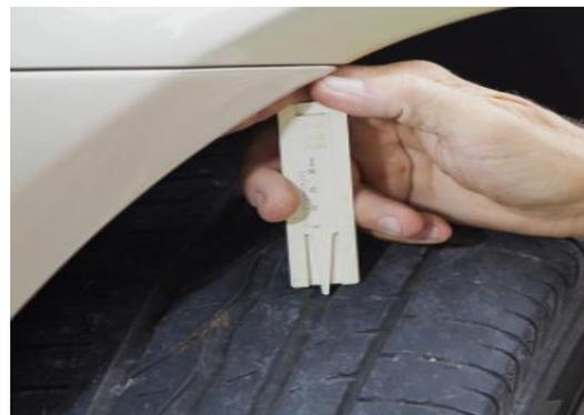
**Figura 23.** Medición de Desgaste con Profundímetro.
