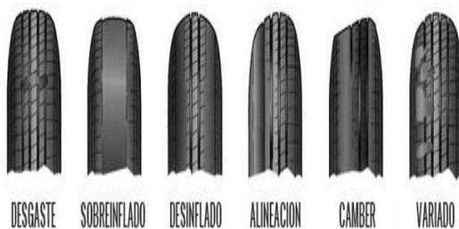
**Figura 26.** Causas del Desgaste del Neumático.
