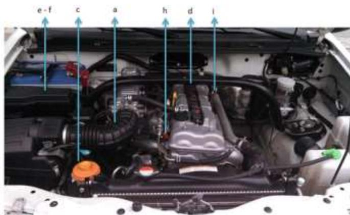
**Figura 34.** Ubicación en el vehículo de los dispositivos controlados del sistema de inyección de combustible del motor J20.
