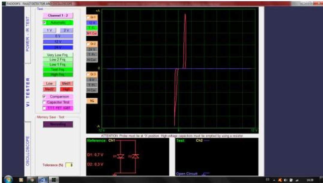
**Figura 89.** Curva V/I conector del actuador Bobina de encendido # 4 a la ECU, terminal #2.
