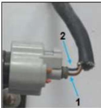
**Figura 9.** Pines de conexión del sensor de temperatura
