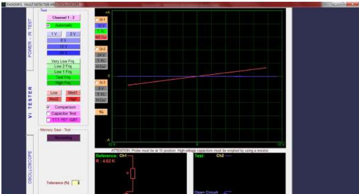
**Figura 99.** Curva V/I sensor TPS, terminal # 2 con respecto al terminal # 1.
