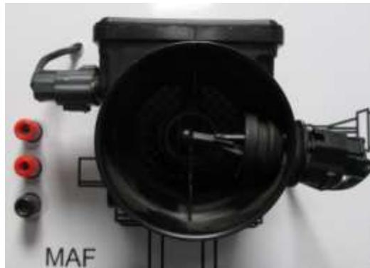
**Figura 5.** Sensor de masa de aire
