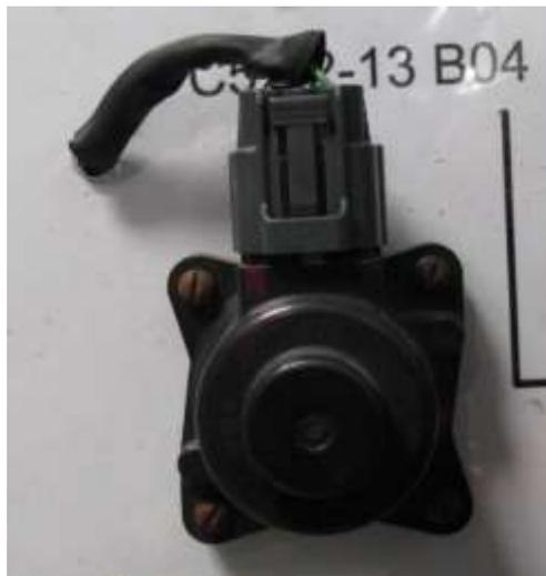
**Figura 24.** Válvula de recirculación de gases de escape.
