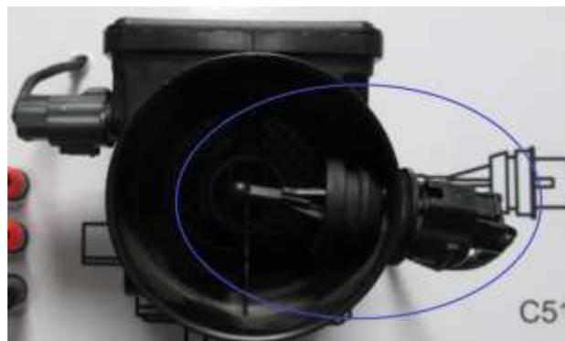
**Figura 12.** Sensor de temperatura de aire
