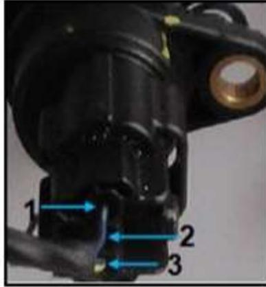
**Figura 21.** Pin de conexión sensor de velocidad
