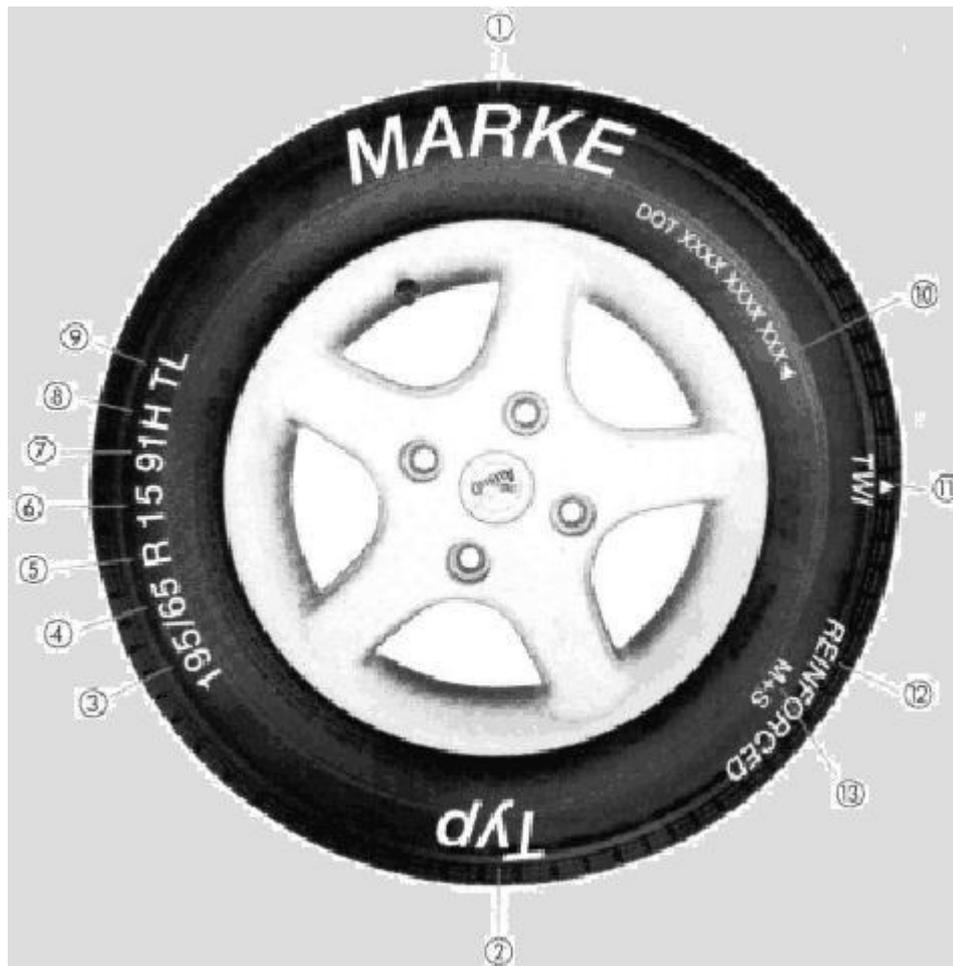
Figura 2. Identificación de los Neumáticos
