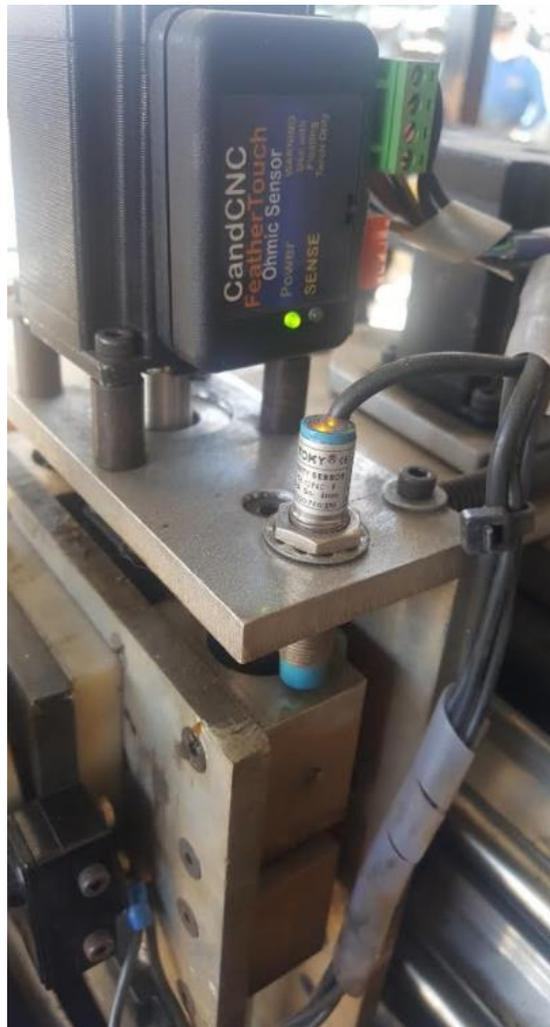
Figura 4. 33. Posicionamiento y activación sensor Eje Z.
