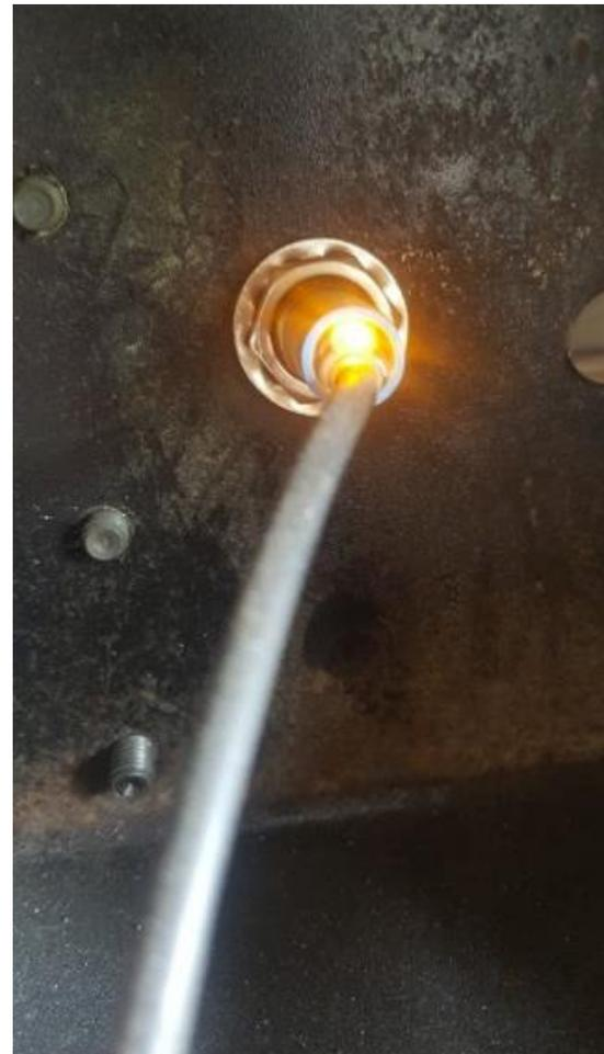
Figura 4. 31. Señal mecánica de activación sensor Eje Y.
