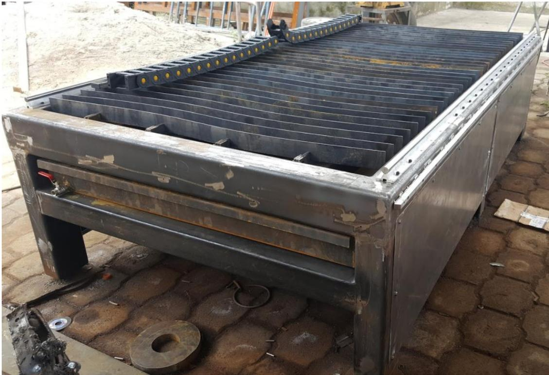
Figura 4. 5. Instalación cremallera - guías lineales - bandejas de agua.
