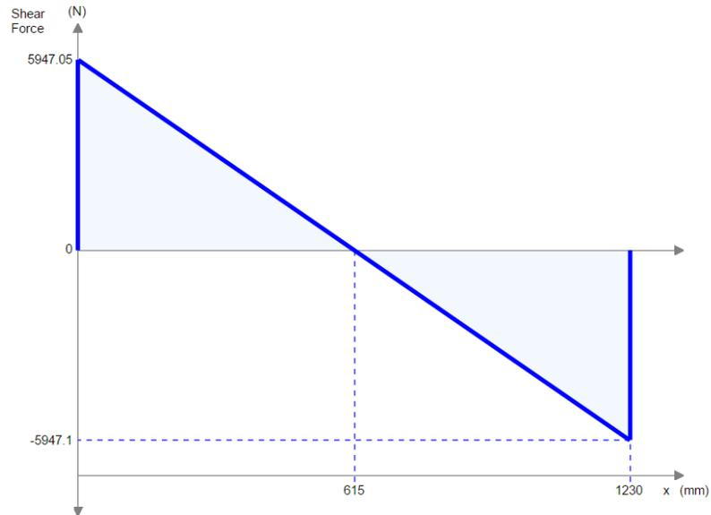
Figura 3. 15. Diagrama de Fuerzas Cortantes Estructura Soporte Plancha.
