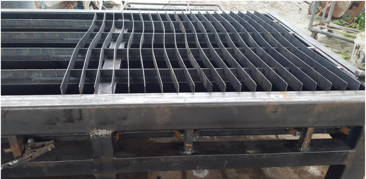
Figura 4. 4. Instalación rejillas de corte
