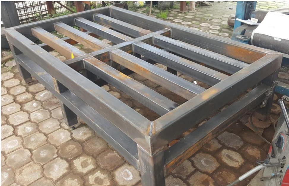
Figura 4. 2. Estructura principal mesa de corte (Eje X).
