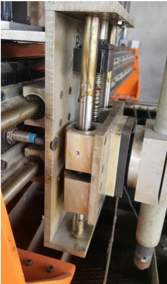
Figura 4. 30. Posición de sensor Eje Y.
