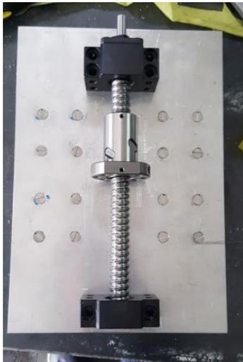
Figura 4. 9. Instalación chumaceras - tornillo de potencia
