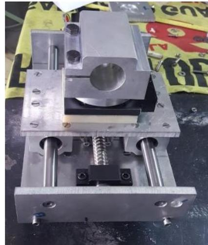
Figura 4. 10. Instalación guías lineales - soporte antorcha.
