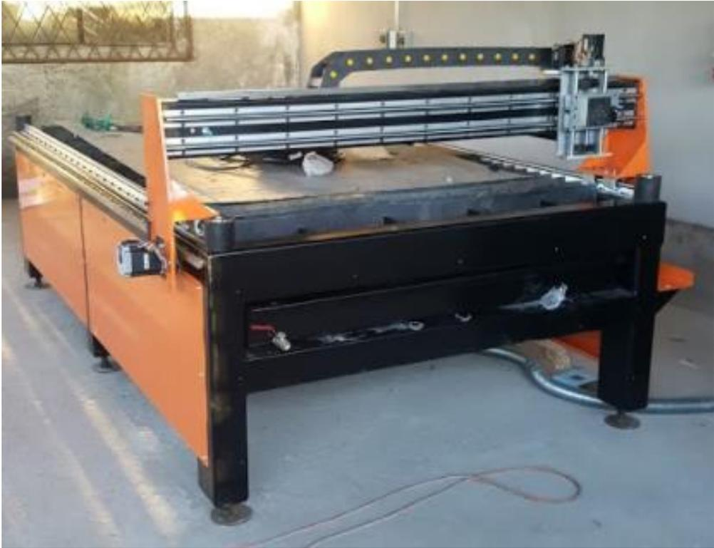
Figura 4. 13. Ensamblaje total CNC cortadora plasma.
