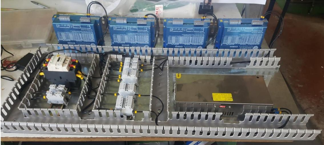
Figura 4. 15. Cabina de control elementos de potencia.
