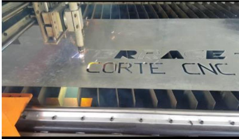
Figura 4. 24. Corte complejo CNC cortadora por plasma.
