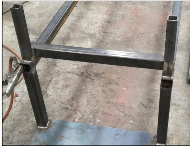
Figura 4.7: Ensamble de la estructura del sistema de separación
