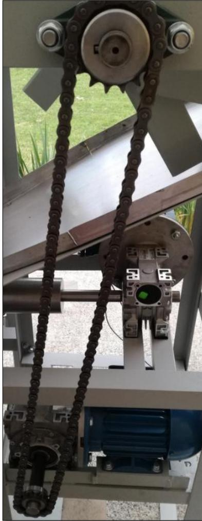
Figura 4.21: Cadena del sistema de fragmentación instalada
