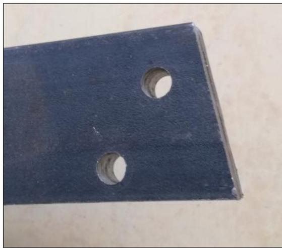
Figura 4.30: Orificios de los pernos de sujeción de las cuchillas fijas
