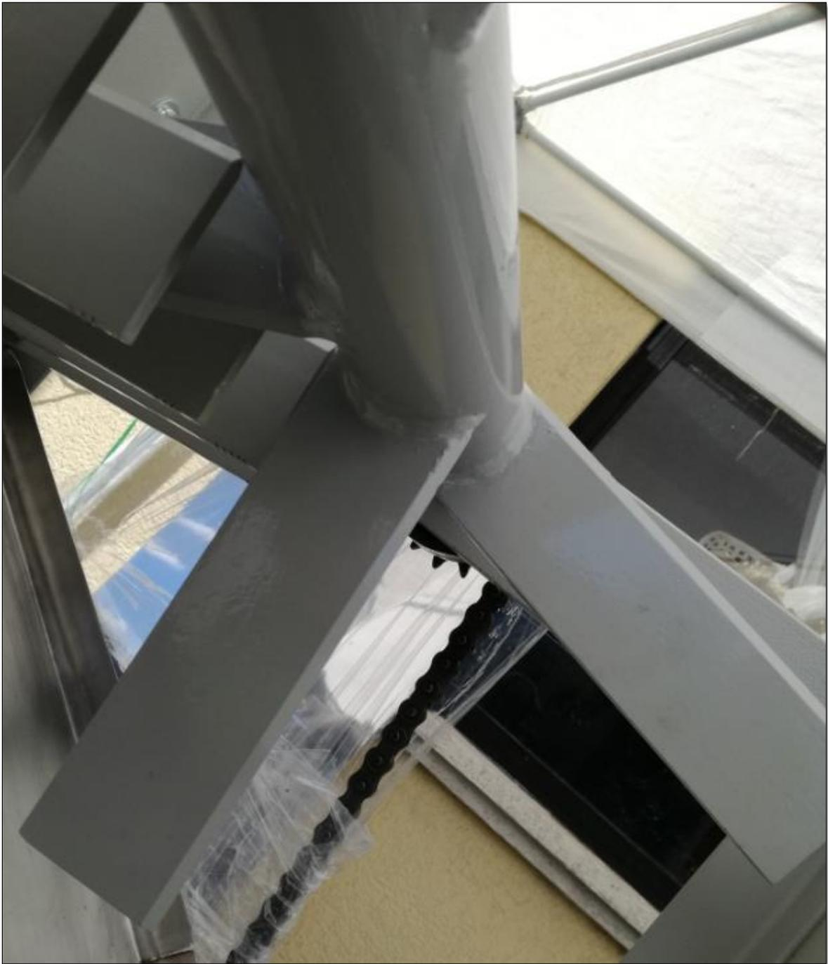
Figura 4.35: Cuchillas fijas y móviles del sistema de fragmentación
