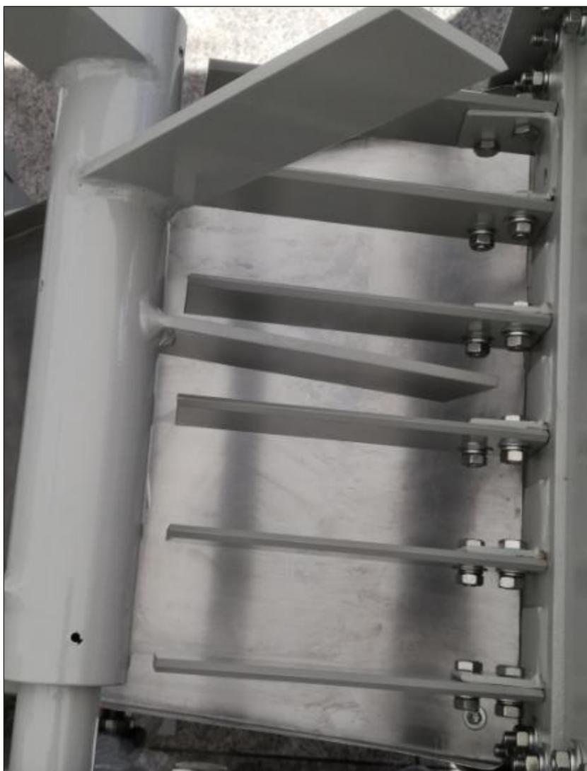
Figura 4.32: Cuchillas fijas instaladas
