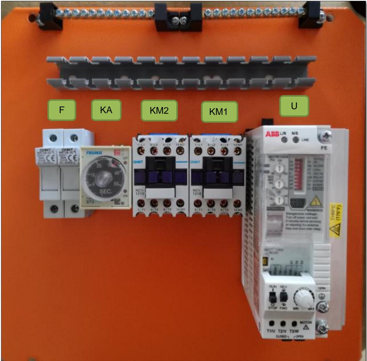
Figura 4.36: Distribución de componentes eléctricos
