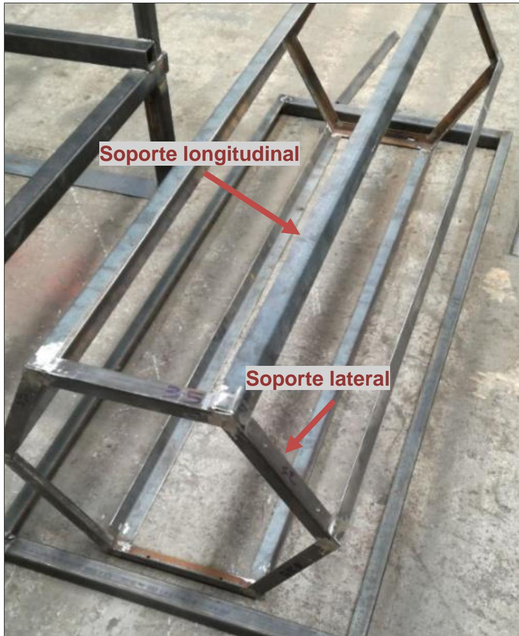
Figura 4.11: Estructura del hexágono de separación.
