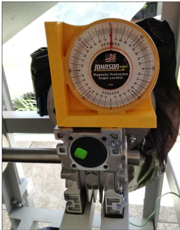
Figura 4.18: Inclinación del motorreductor
