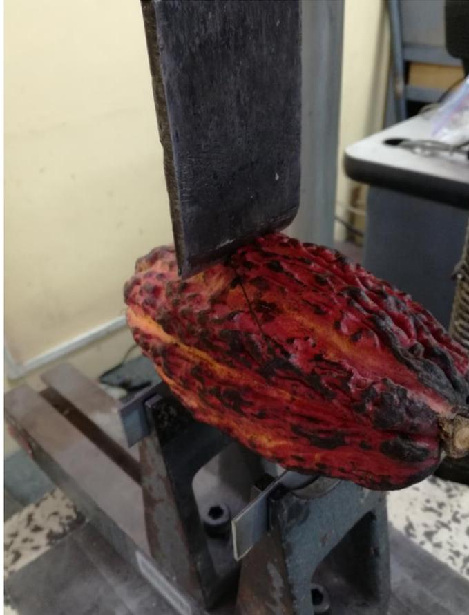
Figura 3.2: Ensayo de compresión
