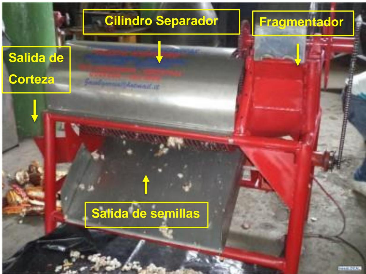
Figura 1.9: Máquina despulpadora de cacao
