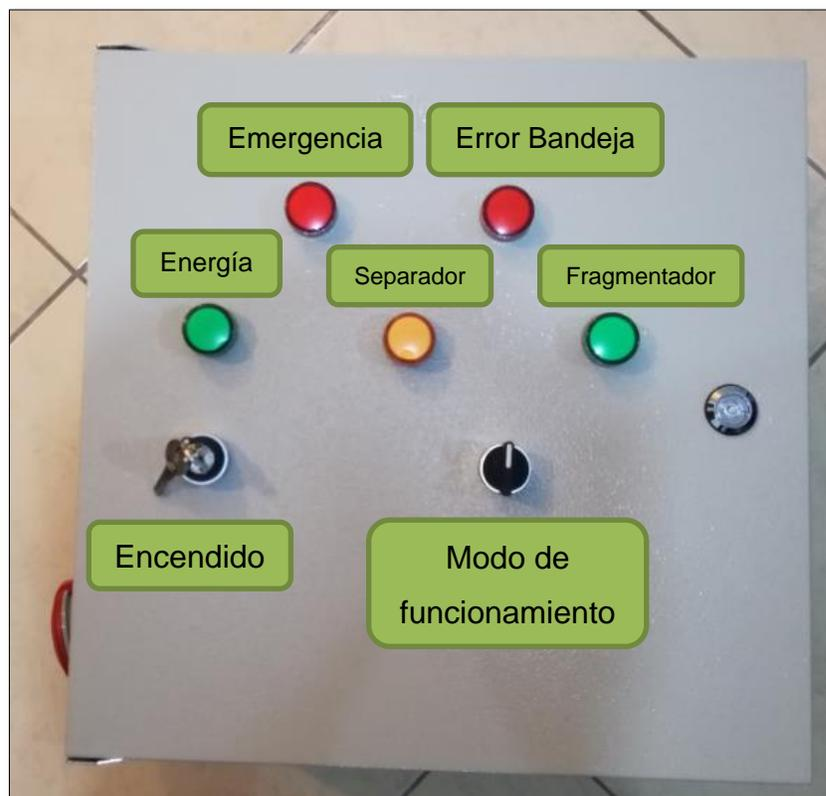
Figura 4.37: Distribución de componentes de control e indicadores
