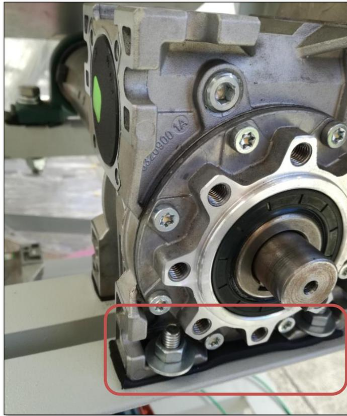
Figura 4.16: Caja reductora del sistema de separación instalada.
