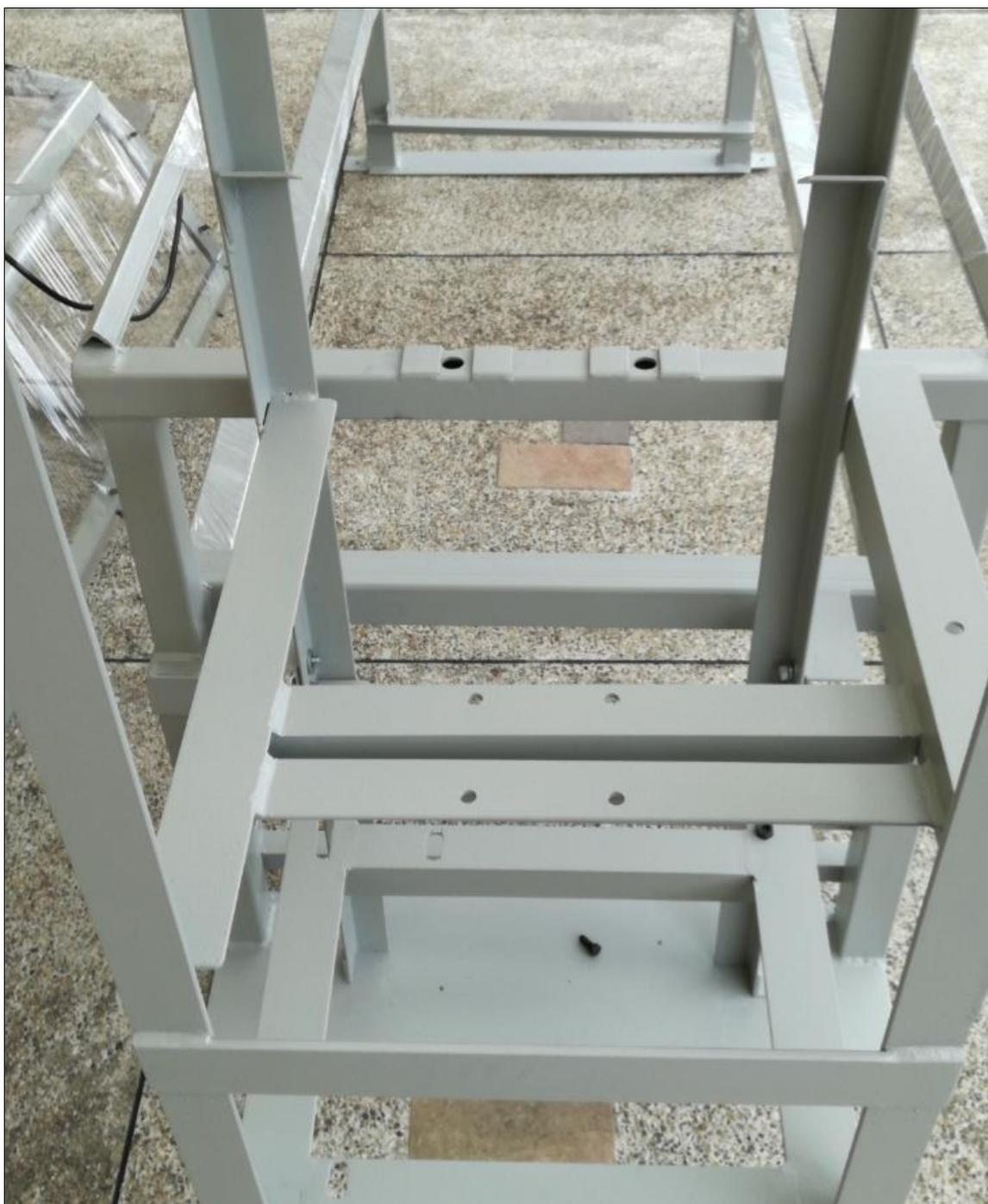
Figura 4.33: Estructura del fragmentador
