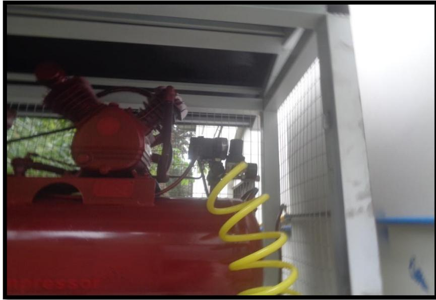
**Figura 5.5** Instalación de la manguera de alta presión
