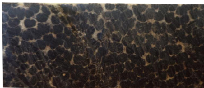
Fotografía 11/ Veteado de la chonta en forma transversal.
