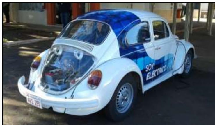
**Figura 7.** Bocho 100% eléctrico con suministro de capacitación y kit de componentes
