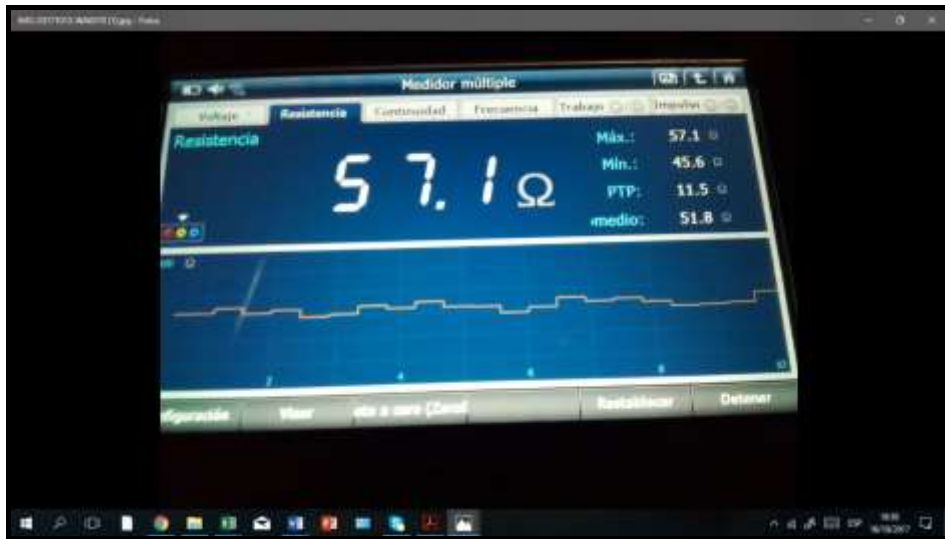
Figura 42. Valor en ohmios del sistema Can bus Fuente: Wilson Chabla Lliguicota
